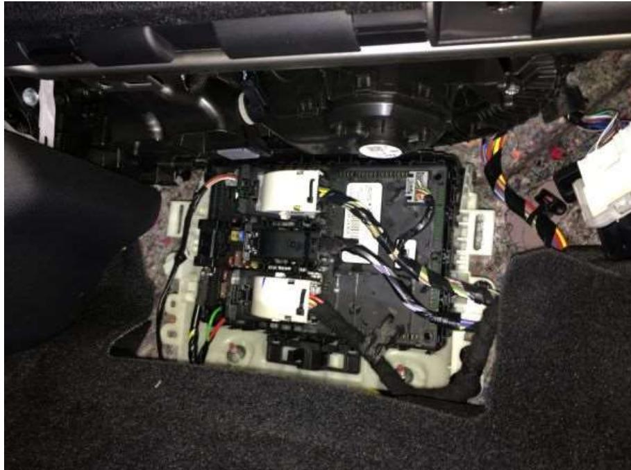
En la figura siguiente se indican los conectores del mazo de cables sobre los que se actuará para las tomas de "Positivo Directo", "Contacto, Bajo Llave o 15", ambos en el conector C2280D y la de "Señal de velocidad" en el conector C2280F.
