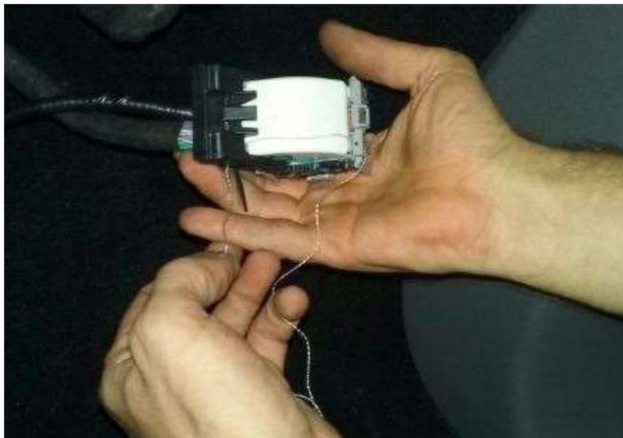
Nótese el alambre pasando alrededor de la leva del mecanismo de anclaje de la clema
