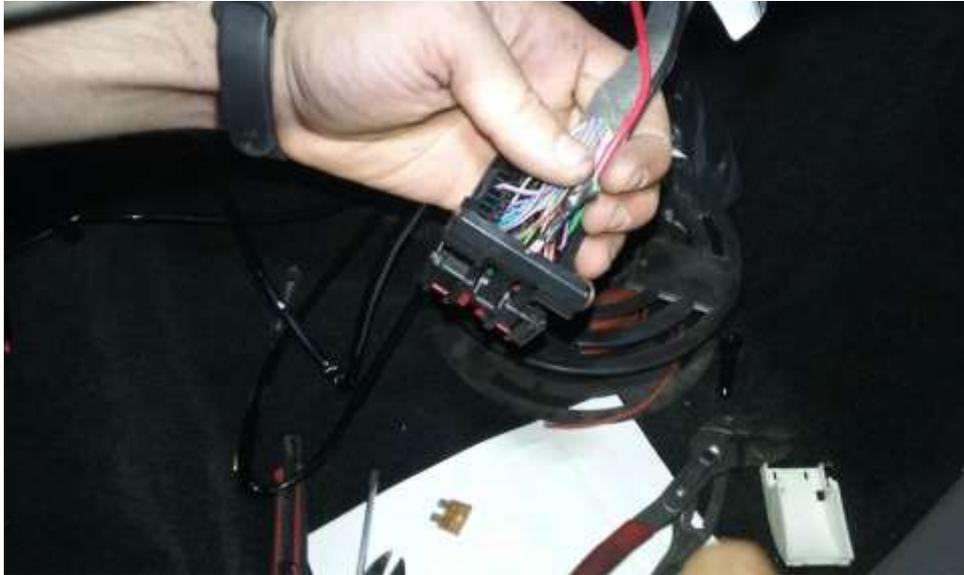
Las conexiones entre los cables se realizarán mediante uniones soldadas y protegidas con cinta aislante. A los cables empalmados se les intercalarán unos porta fusibles.
