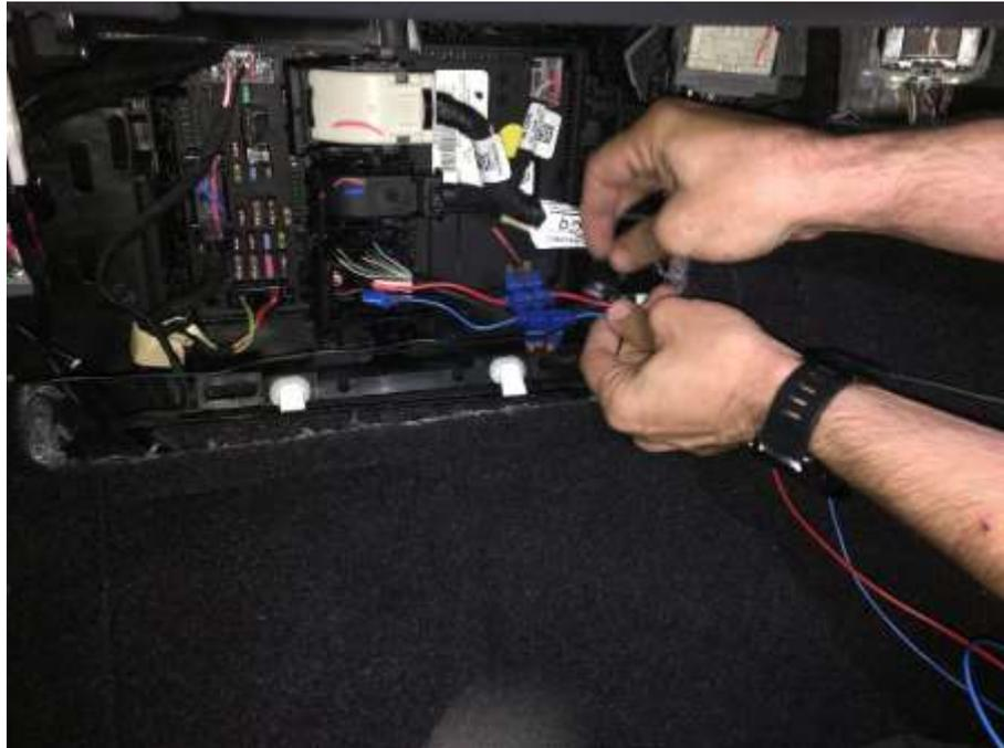
Las conexiones entre los cables se realizarán mediante uniones soldadas y protegidas con cinta aislante. Recordemos no obstante, que para cables de menor sección siempre podemos usar empalmes rápidos ("cocodrilos")
