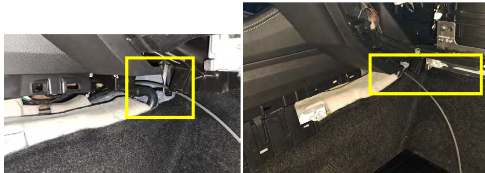
Fig. 2.4. Zona del paso de cables lado del pasajero
