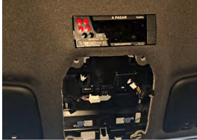
Fig. 4.2.3. Taxímetro de consola simple de techo instalado.
