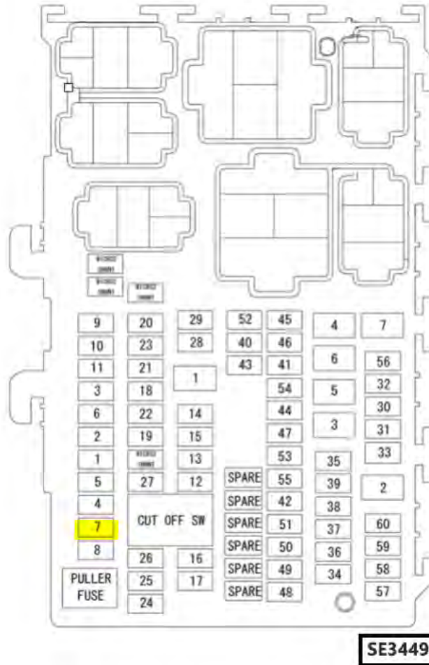
Fig. 2.1. Esquema de la Caja de Fusibles, indicando Nº 7.
