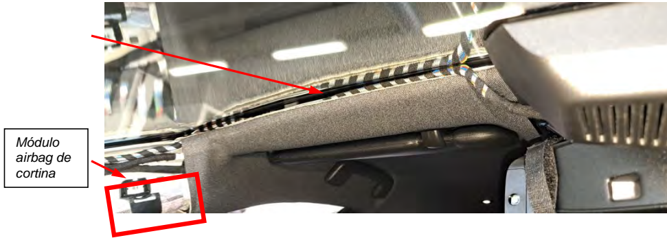
Fig. 4.3. Recorrido de los cables hasta el taxímetro de espejo por el tapizado de techo.
