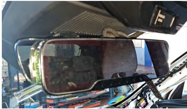
Fig. 4.4. Taxímetro de espejo superpuesto instalado.
