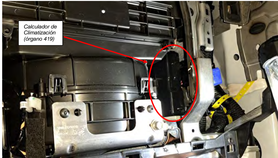
Fig. 1.1. Vista de la ubicación del calculador de Climatización (órgano 419), detrás de la guantera.
