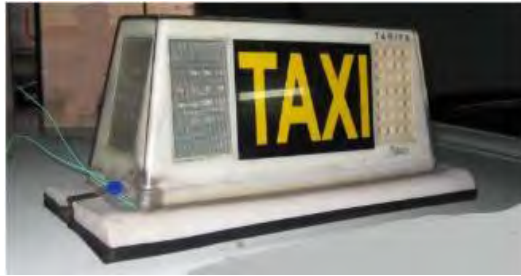
Fig. 6.1.3. Vista del módulo y su precinto
