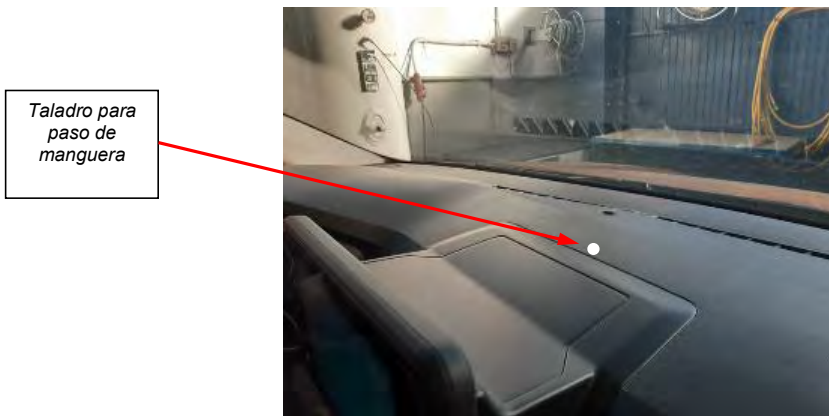
Fig. 4.1.2. Detalle taladro para paso de manguera
