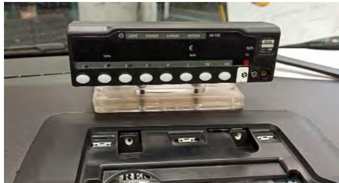
Fig. 4.1.1.2. Ubicación de taxímetro consola sobre salpicadero con pantalla
