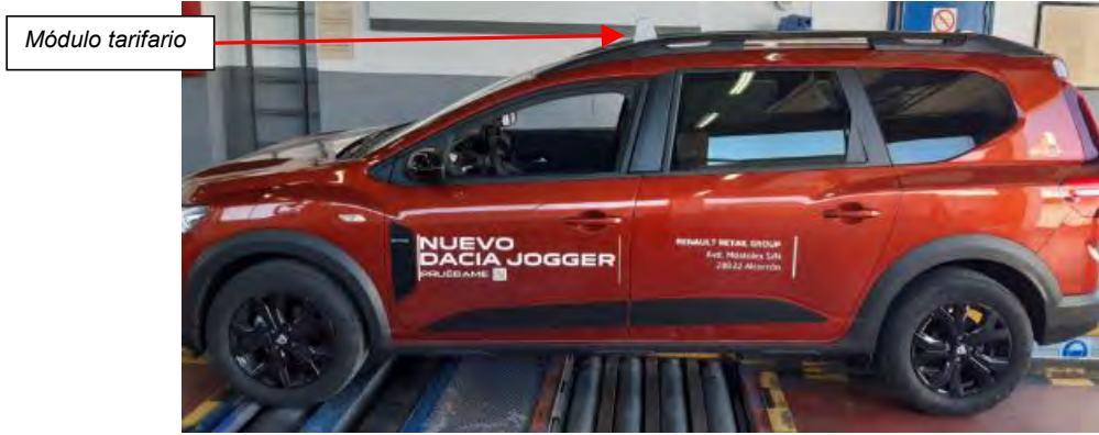
Fig. 6.2. Vista lateral ejemplo módulo centrado atornillado
