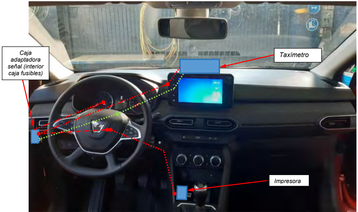
Fig. 4.1.1 Esquema orientativo del recorrido de las conexiones para taxímetros sobre salpicadero .
