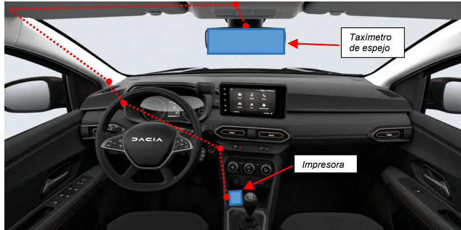
5.2.1. Recorrido cable de taxímetro de espejo.
