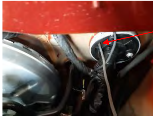
Fig. 2.2. Detalle pasamuros, vista compartimento motor
