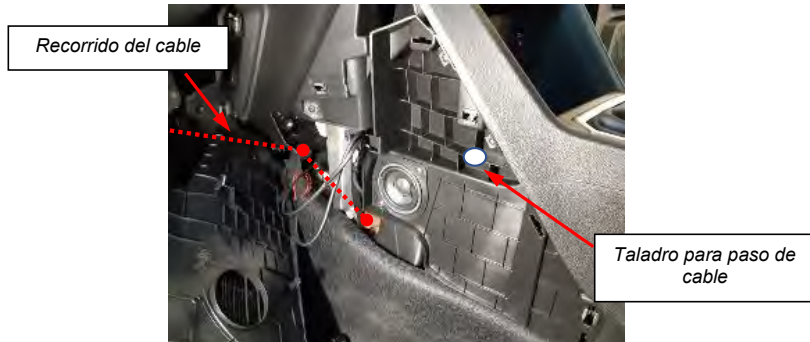
Fig. 5.2.2. Recorrido cable impresora hueco portaobjetos central.
