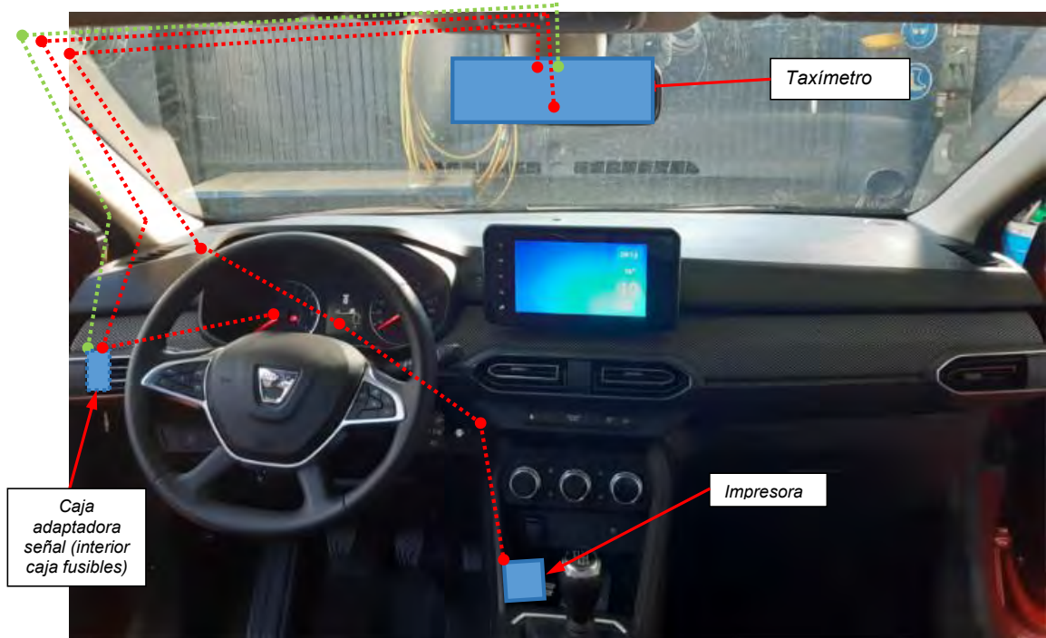
Fig. 4.2.1. Esquema orientativo del recorrido de las conexiones para taxímetros de espejo
