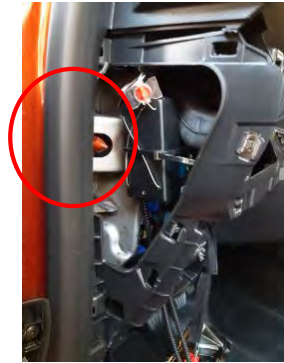
Fig. 4.2.5. Zona de paso del cableado
