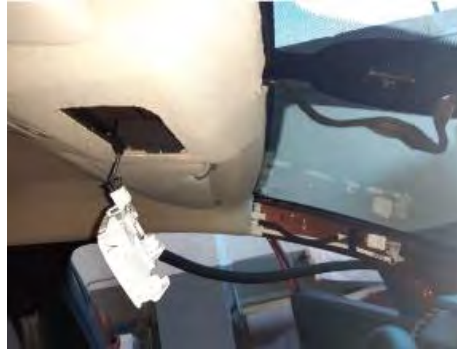
Fig. 4.2.2. Vista del plafón desmontado.
