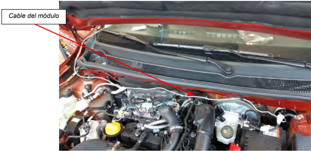
Fig. 6.6 Vista del recorrido del cable módulo luminoso por el cofre motor
