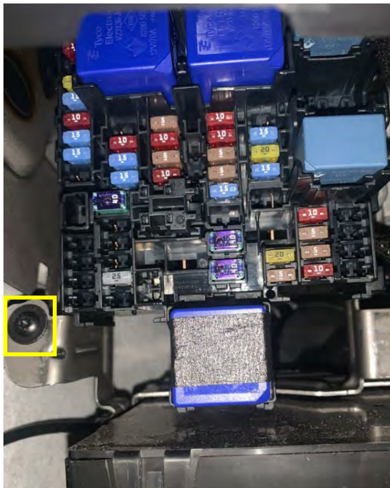
Fig. 2.6. Detalle de conexión negativo de masa a chasis.
