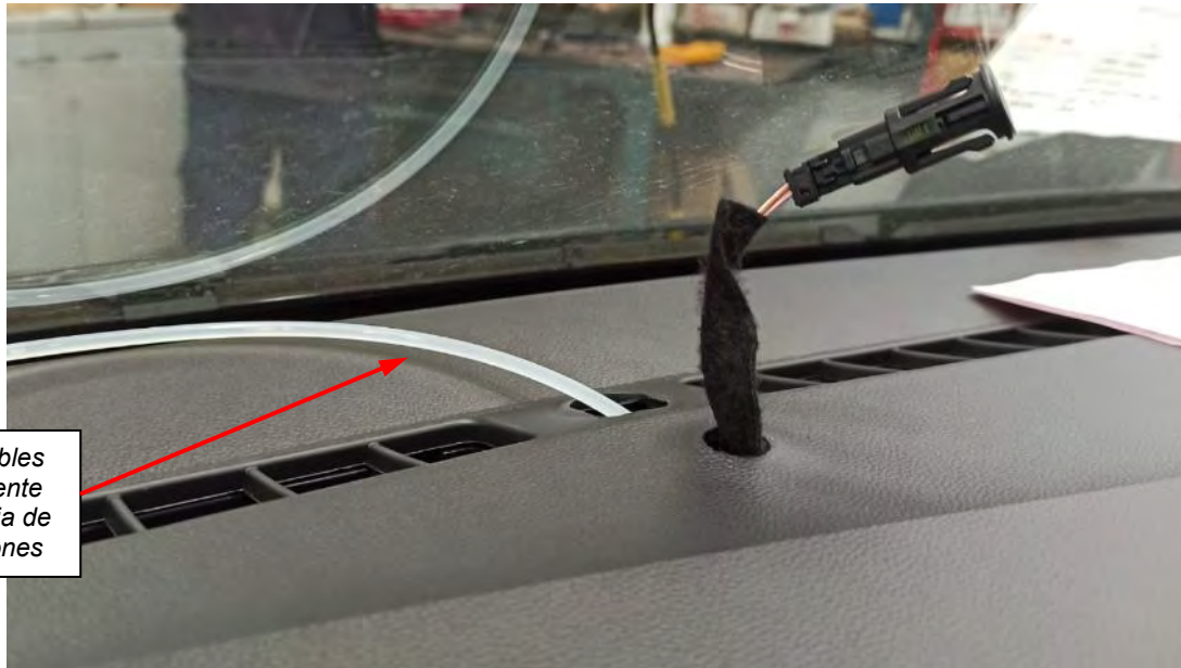
Fig. 4.3. Vista del paso de la manguera a la zona superior del salpicadero.
