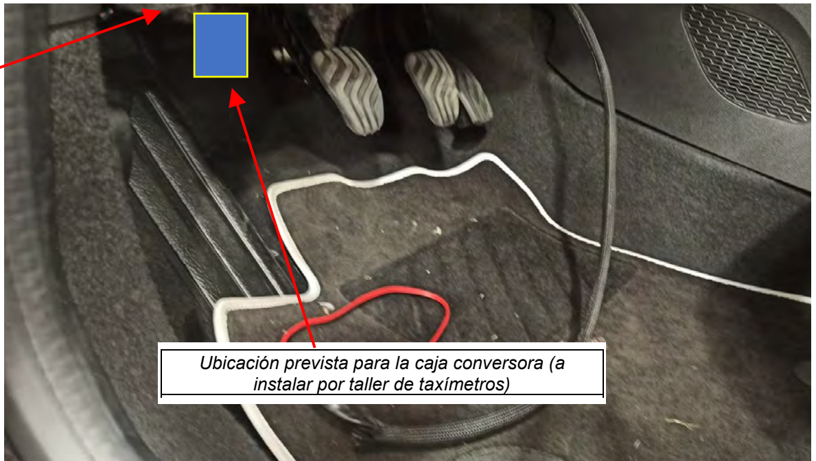
Fig. 2.2.4. Detalle ubicación de caja conversora de señal.
