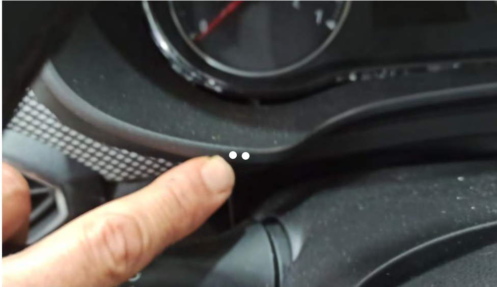
Fig. 2.5. Identificación de los taladros para el paso de alambre de precinto.
