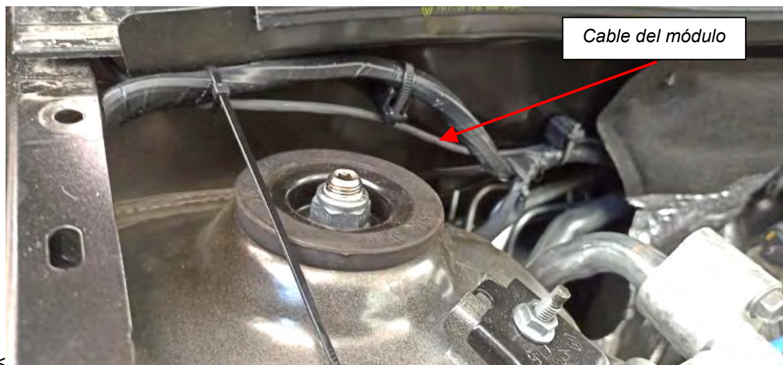
Fig. 6.6 Vista del recorrido del cable módulo luminoso por el cofre motor
