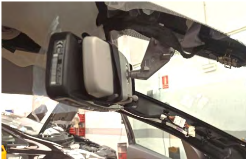
Fig. 4.2.1.3. Vista de taxímetro de espejo superpuesto.
