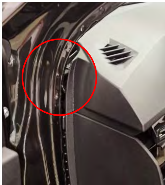
Fig. 4.2.3. Zona de paso del cableado
