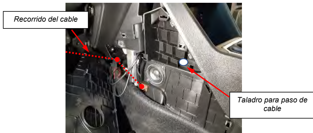
Fig. 5.2.2. Recorrido cable impresora hueco portaobjetos central.
