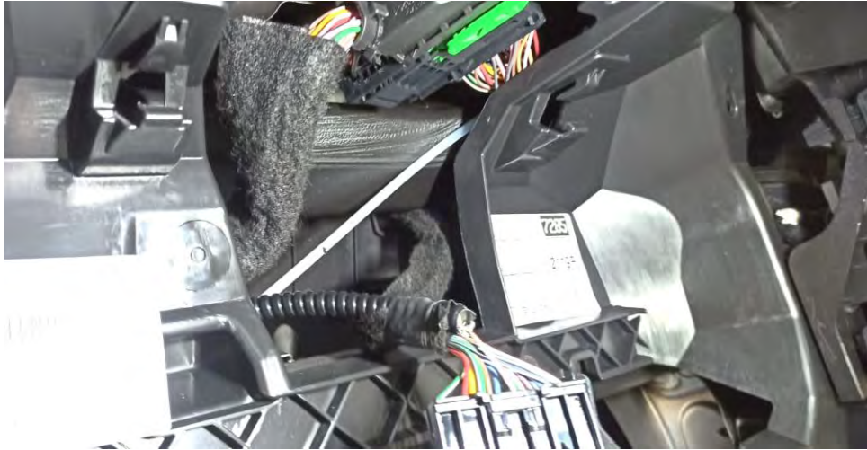
Fig. 2.2. Detalle paso de manguera blindada a la zona posterior del cuadro desde el conector 247
