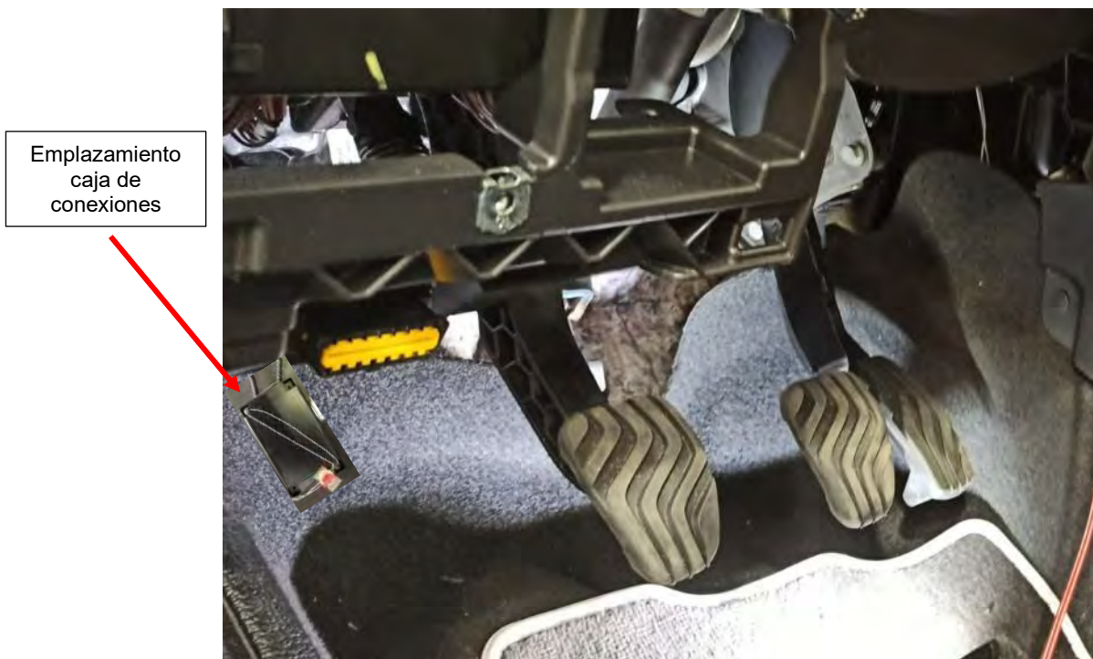
Fig. 3.1.4. Vista de la caja de conexiones precintada e instalada con velcro encima del reposapiés
