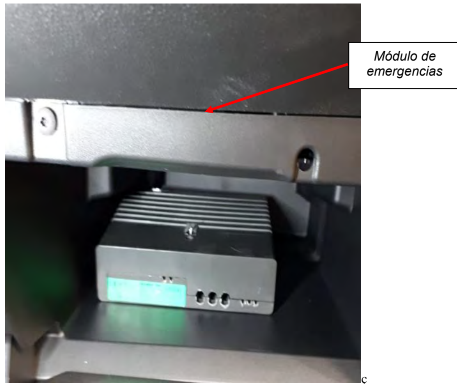
Fig. 7.1. Vista del módulo de emergencias en la guantera.
