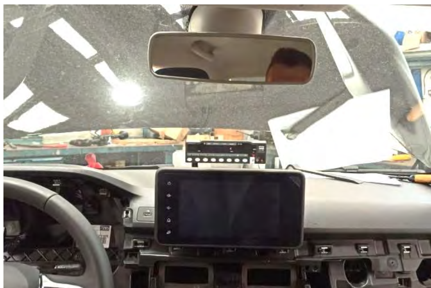
Fig. 4.1.1.3. Vista posterior de taxímetro consola sobre salpicadero.
