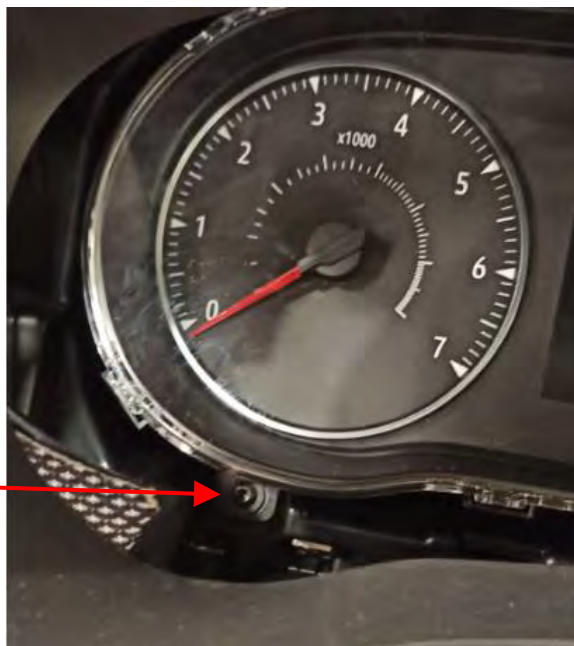
Fig. 2.4. Identificación del punto de amarre del alambre del precinto.
