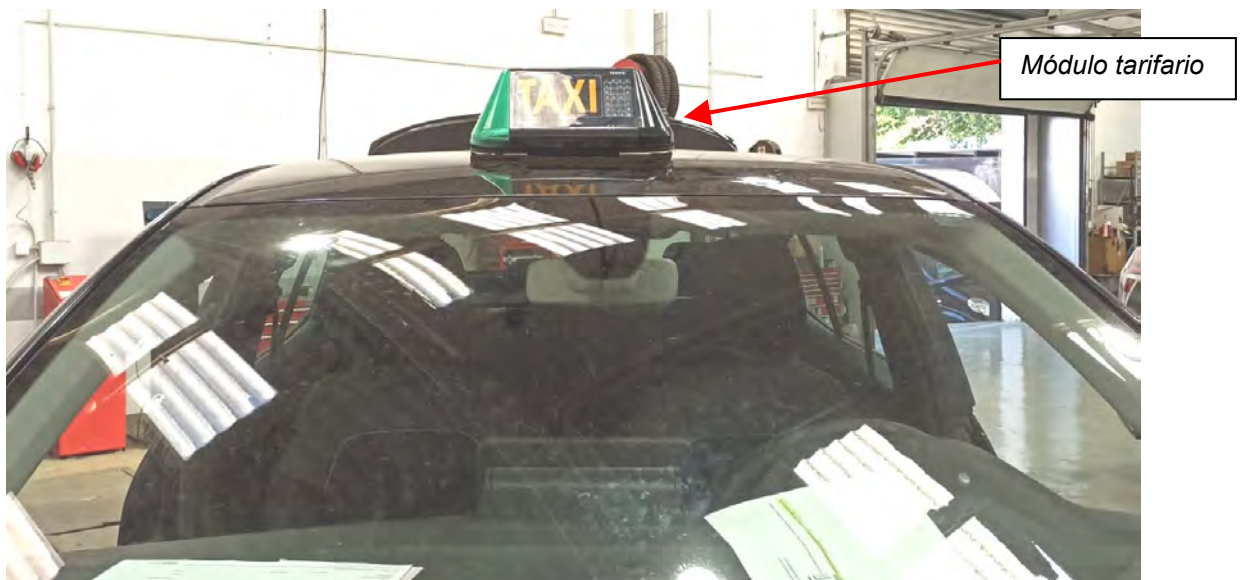
Fig. 6.1. Vista frontal ejemplo módulo centrado atornillado
