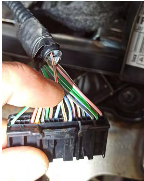
Fig. 1.3. Vista del conector 247 del cuadro de instrumentos
