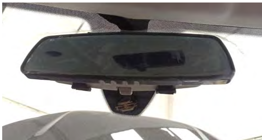
Fig. 4.2.1.2. Vista del taxímetro de espejo
