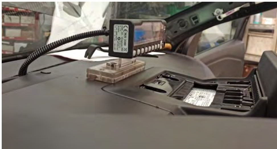
Fig. 4.1.1.1 y 4.1.1.2. Vistas de la ubicación de taxímetro consola sobre salpicadero.
