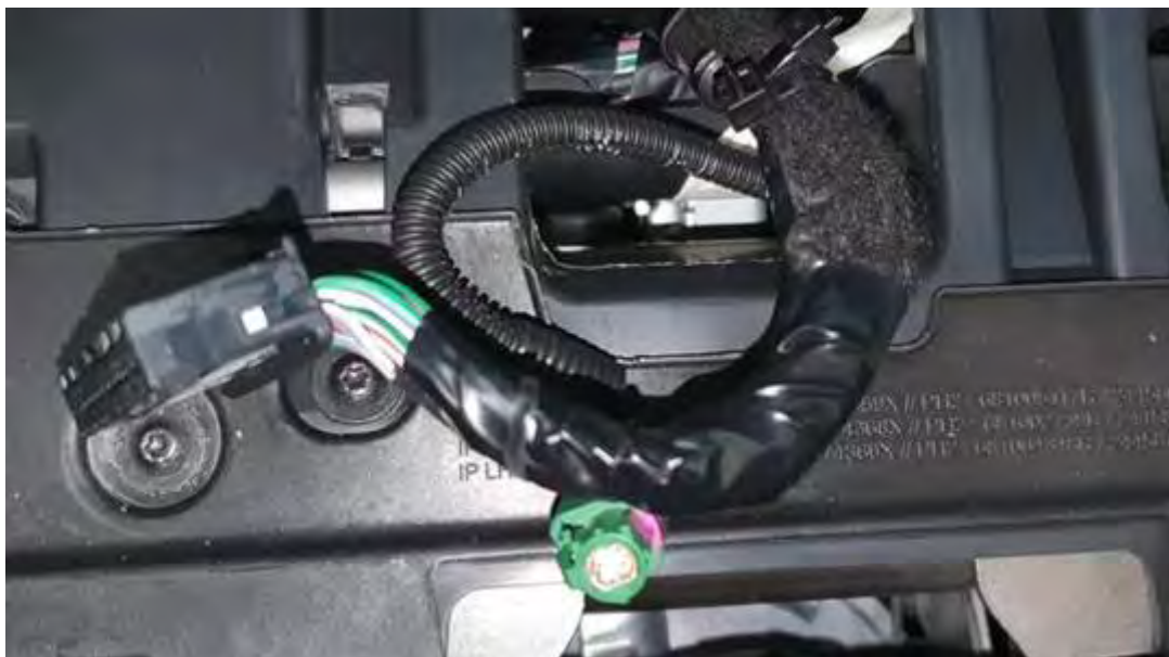
Fig. 2.2.3. Detalle conexión cable y manguera blindada al conector 247
