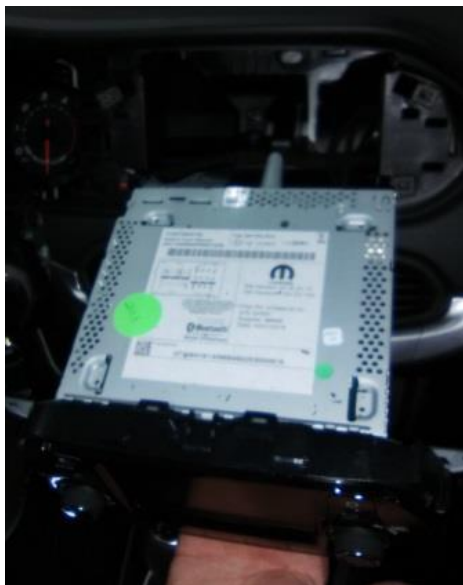
Extraemos el aparato de radio e introducimos la guía hacia abajo para llegar a la centralita Body Computer y subir el cableado para el taxímetro, luminoso, impresora, gestión de flotas, 112 etc...
