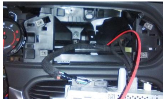
Extraemos el aparato de radio e introducimos la guía hacia abajo para llegar a la centralita Body Computer y subir el cableado para el taxímetro, luminoso, impresora, gestión de flotas, 112 etc...
