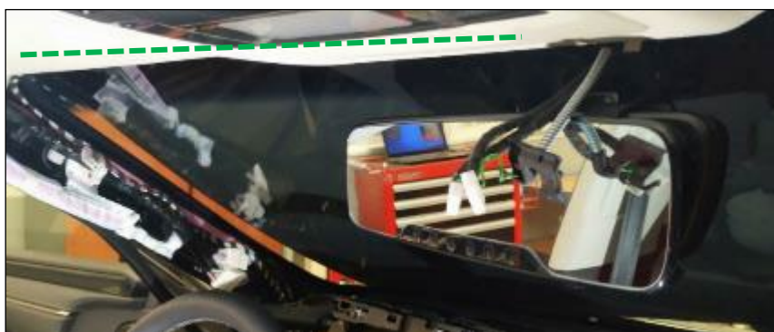
Recorrido del cable del módulo tarifario
