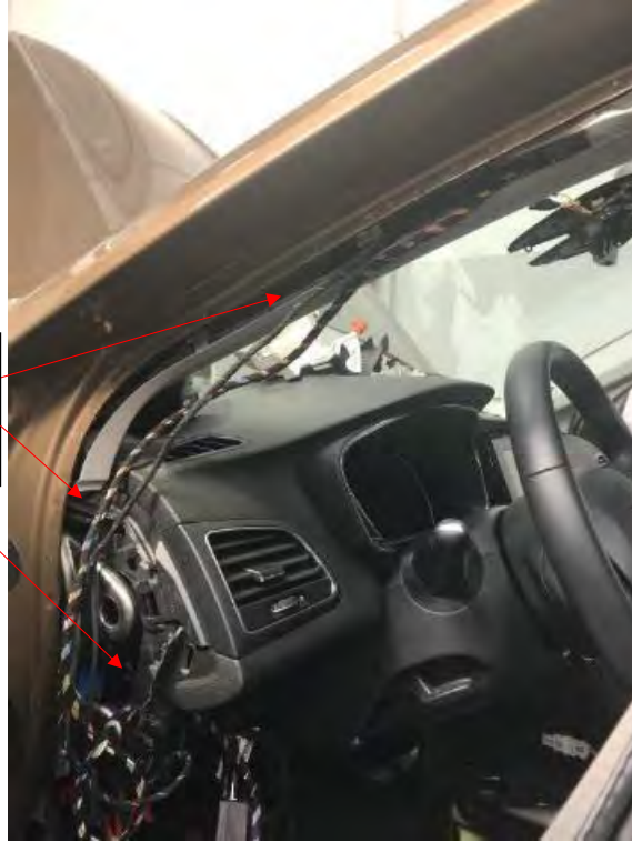
Fig. 4.6. Entrada de cables al interior del salpicadero.
