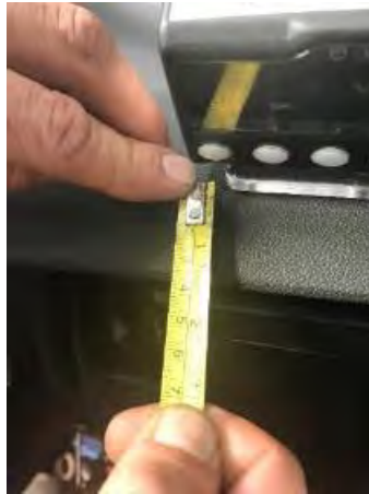
Fig. 5.2. Separación taxímetro a borde salpicadero.
