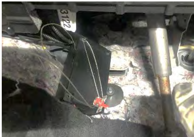
Fig. 3.1.4. Vista del de la caja de conexiones precintada e instalada con velcro encima del reposapiés, bajo el salpicadero
