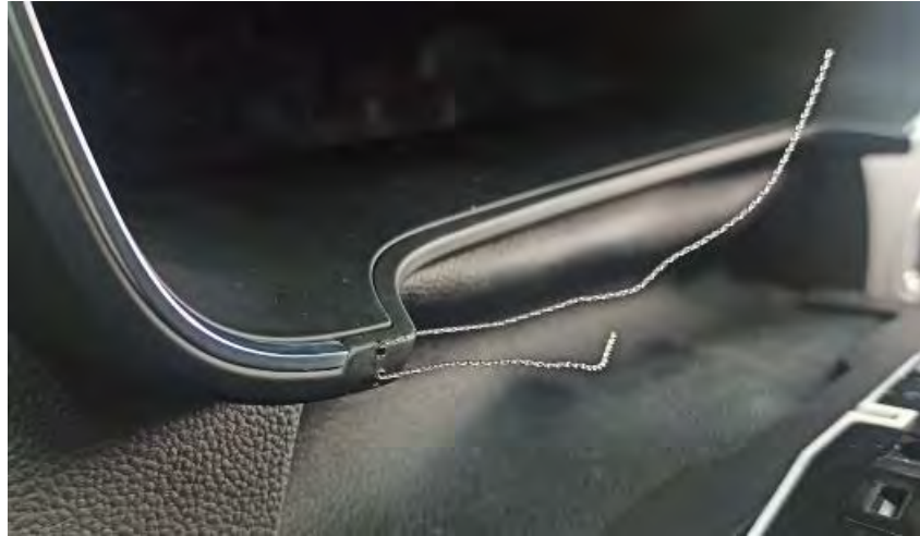
Fig. 2.3.2. Detalle del paso de alambre de precinto.
