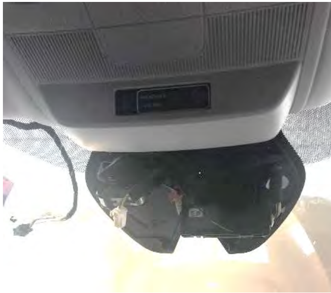
Fig. 5.3. Vista de punto de anclaje del soporte del espejo.
