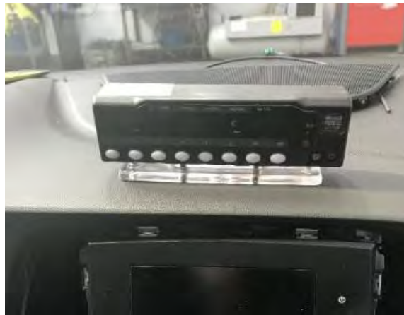
Fig. 5.1. Ubicación taxímetro consola sobre salpicadero.
