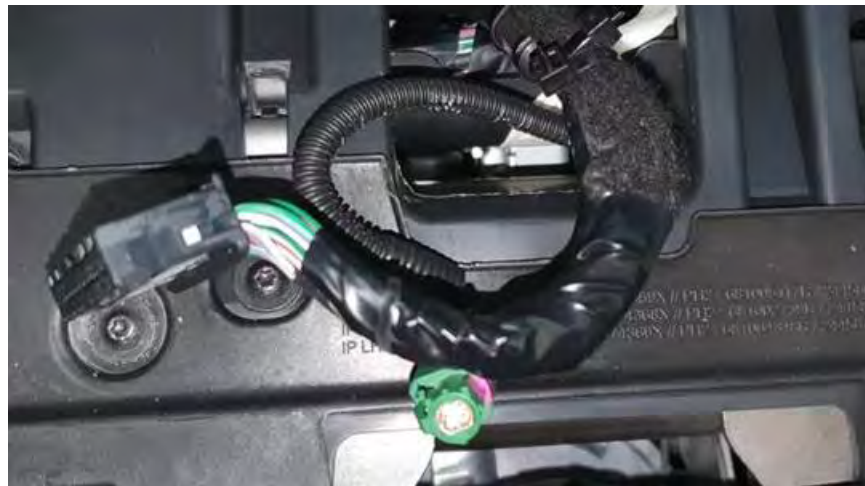
Fig. 2.1.3. Detalle conexión cable y manguera blindada al conector 247
