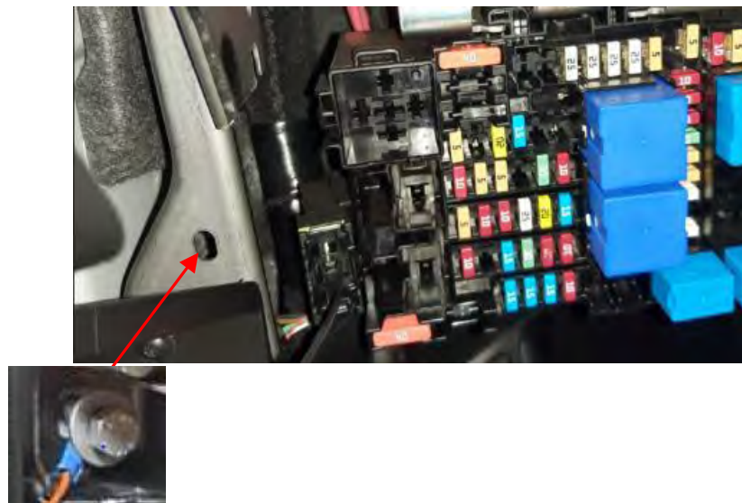
Fig. 2.7. Detalle de conexión negativo de masa a chasis.
