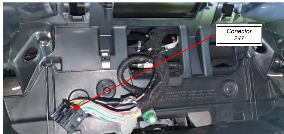
Fig. 1.1. Esquema general de conectores, zona conductor
