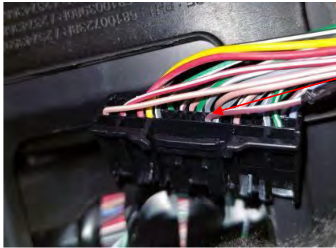
Fig. 2.1.1. Detalle cable señal del pin nº 12 del conector 247
