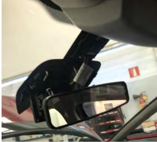
Fig. 5.4. Vista del taxímetro de espejo sobre el soporte original del retrovisor interior
