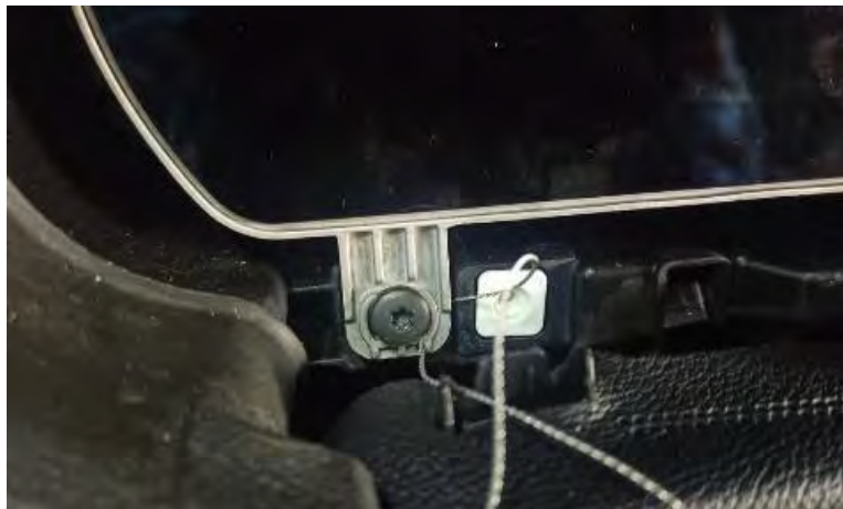
Fig. 2.3.1. Detalle del alambre de precinto.
