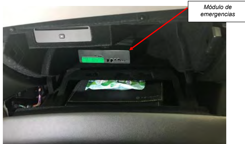
Fig. 7.1. Vista del emplazamiento del módulo de emergencias.
