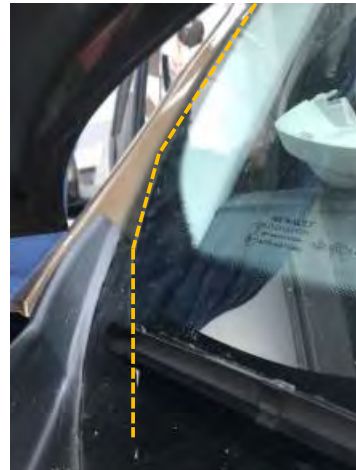
Fig. 6.5 y 6.6. Vistas del paso de cable del módulo al compartimento motor
