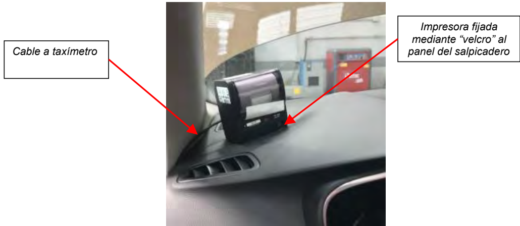
Fig. 5.6. Vistas de la disposición de la impresora.
