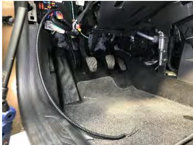
Fig. 3.1. Vista de la terminación de la manguera blindada puesta por el concesionario
