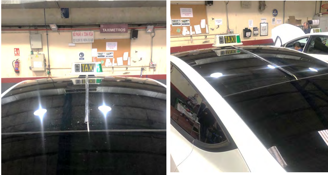
Vistas del cable del módulo centrado desde la trasera del vehículo
