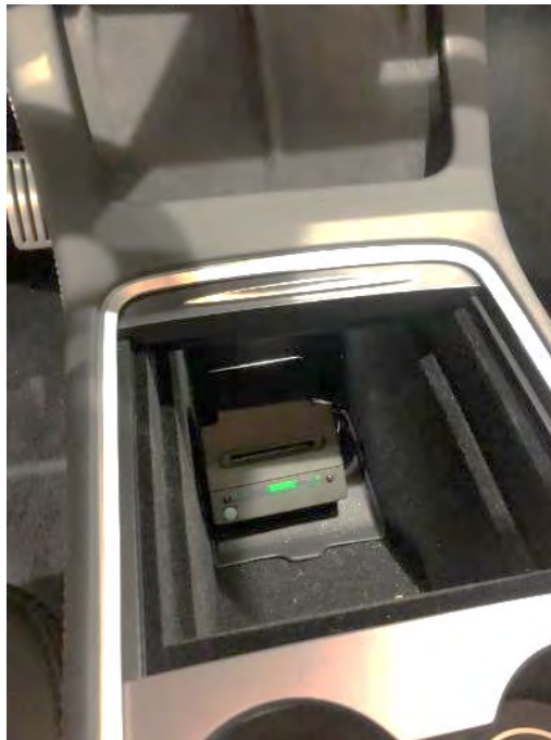
Fig. 9. Vista de la impresora en su ubicación prevista en la guantera central.
