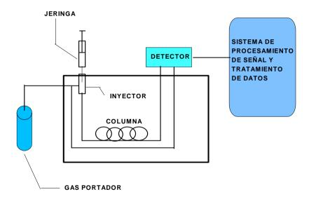
La cromatografía se puede emplear para la identificación cualitativa y para la determinación cuantitativa de las especies separadas. La cromatografía en columna cuantitativa se basa en la comparación de la altura, o del área, del pico del analito con la producida por una o más disoluciones o diluciones del analito de concentración conocida.
