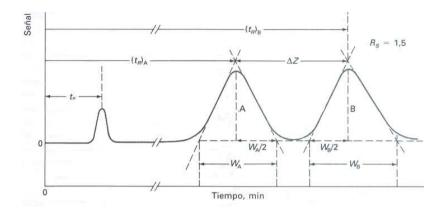
Con un valor  $R_{\rm s}$  > 1,5 se permite la separación completa de dos componentes
