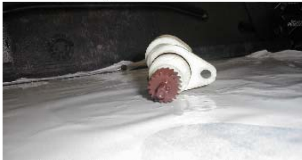
Piñón del captador de velocidad
