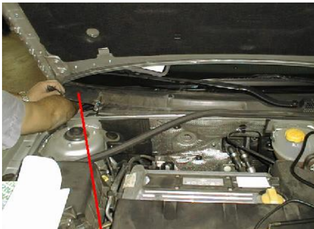
Para acceder al paso interior se ha de levantar el protector de goma del vierteaguas
