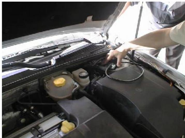
La caja adaptadora de señal se situará encima de la torreta del amortiguador izquierdo, fijada mediante tornillos. La ubicación de la caja adaptadora de señal no impedirá la posible sustitución del amortiguador.
