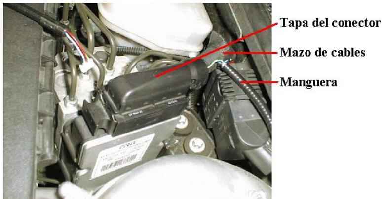
Se coloca la abrazadera metálica a la salida de cables del conector, de forma que encaje la tapa del protector con la clema hembra. Las dos mangueras estarán juntas, sin que ningún cable de las mangueras quede a la vista fuera del conector. Además, se comprobará que funcione correctamente el cuentakilómetros del vehículo.
