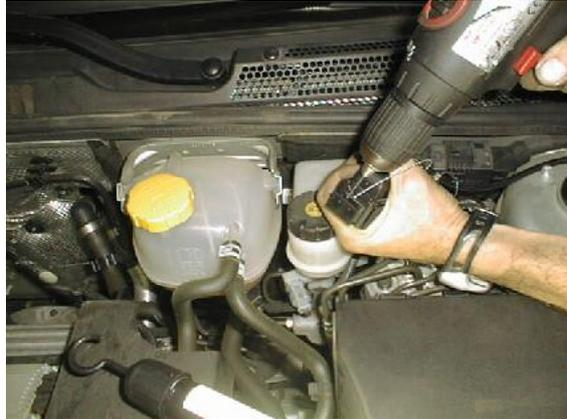
Se coloca la tapa del conector. Se coloca la salida de la manguera del conector de forma que quede juntamente con la salida del mazo de cables del conector, y que estén suficientemente pegadas para que se pueda poner la tapa del conector.
