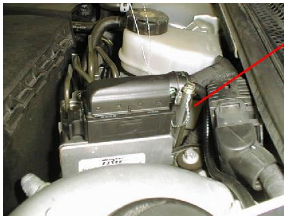
Paso del cable corrugado por detrás del conector
