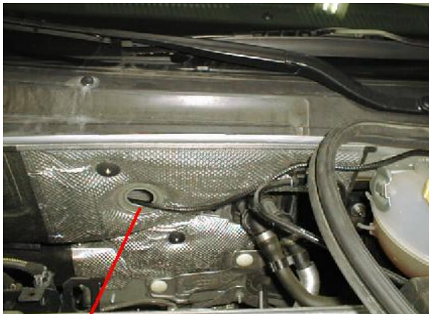
Paso en el tabique por el que se accede a la zona intermedia del vierteaguas
