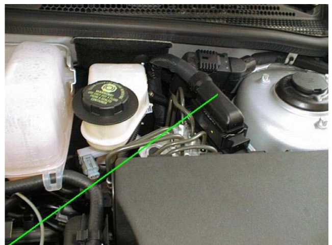
Toma de señal de la Unidad Central del ABS
