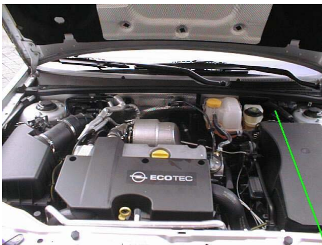
Toma de señal de la Unidad Central del ABS
