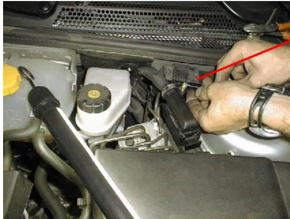
Paso del cable corrugado por el orificio en la abrazadera
