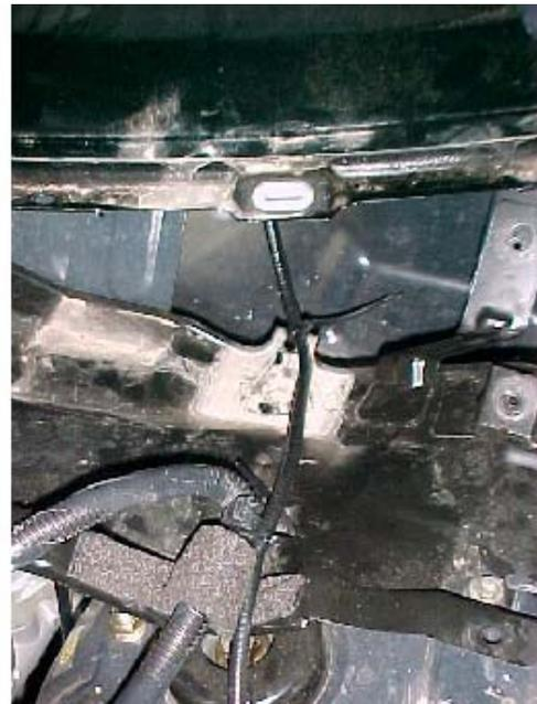
Se instalará la caja de conexiones en el amortiguador delantero derecho.
