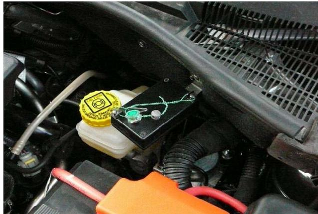
Por esta caja pasan las alimentaciones del aparato taxímetro y la manguera del módulo luminoso repetidor de tarifas. En caso que la manguera del módulo repetidor de tarifas vaya directamente al aparato taxímetro y la manguera de alimentación directa a batería con el porta-fusibles, entonces no será necesario instalar caja de conexiones.
