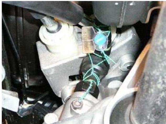
La manguera viene conectada por el concesionario oficial FIAT e irá conectada a la caja adaptadora de impulsos que será instalada por la entidad reparadora-instaladora de aparatos taxímetros. Esta manguera llevará un casquillo con unos encajes para que esté retenida una vez instalada en la caja adaptadora. Una vez instalada hace del todo inviolable dicha señal. Esta caja adaptadora de impulsos estará ubicada y sujeta con unos tornillos al lado del depósito del agua del radiador.
