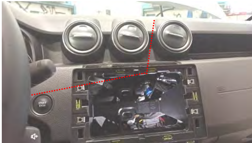
Fig. 4.2. Recorrido de la manguera de señal por la zona central del salpicadero
