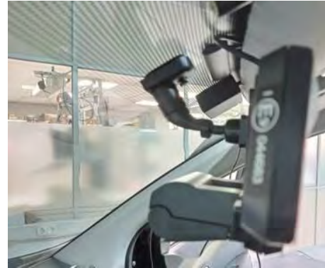
Fig. 4.8 y 4.9. Vistas del taxímetro de espejo con impresora sobre soporte propio.
