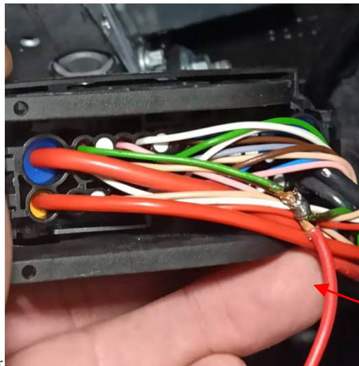
Fig. 2.4. Detalle de conexión del cable de señal
