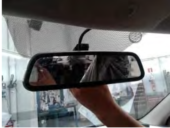
Fig. 4.7. Vista del taxímetro de espejo sobre soporte original del vehículo
