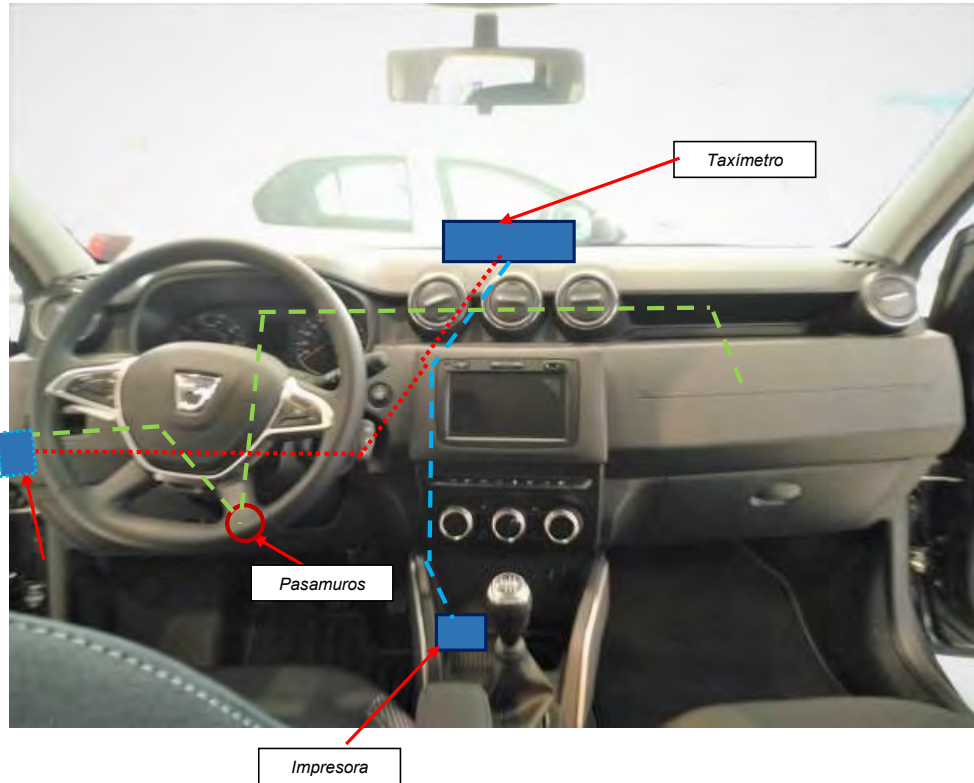
Fig. 4.1. Esquema orientativo de las conexiones taxímetro en salpicadero.
