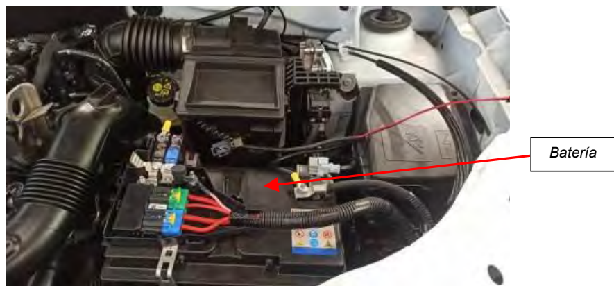
Fig. 1.2. Vista del alojamiento motor. Ubicación de la batería.
