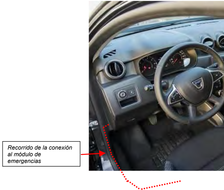
Fig. 7.3. Vista del recorrido de las conexiones del módulo de emergencias.
