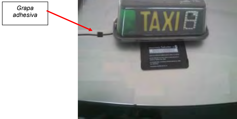
Fig. 6.4. Recorrido cable por el techo
