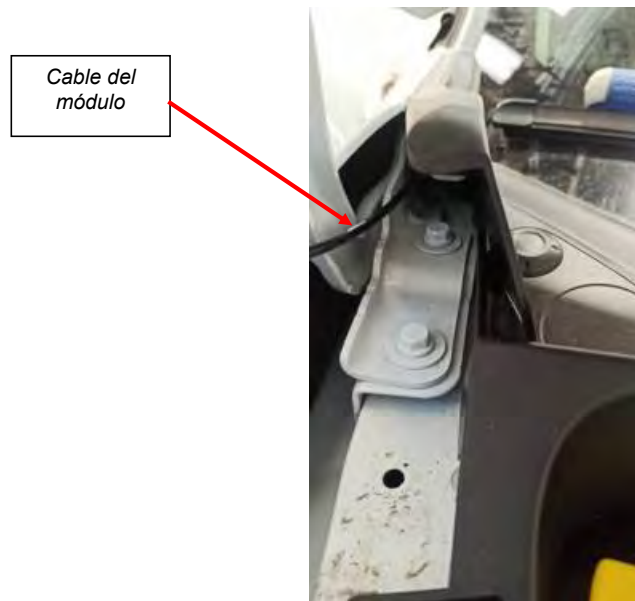
Fig. 6.5. Paso de cable al compartimento motor
