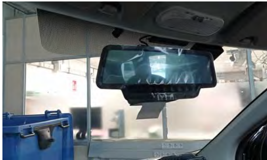
Fig. 4.8 y 4.9. Vistas del taxímetro de espejo con impresora sobre soporte propio.
