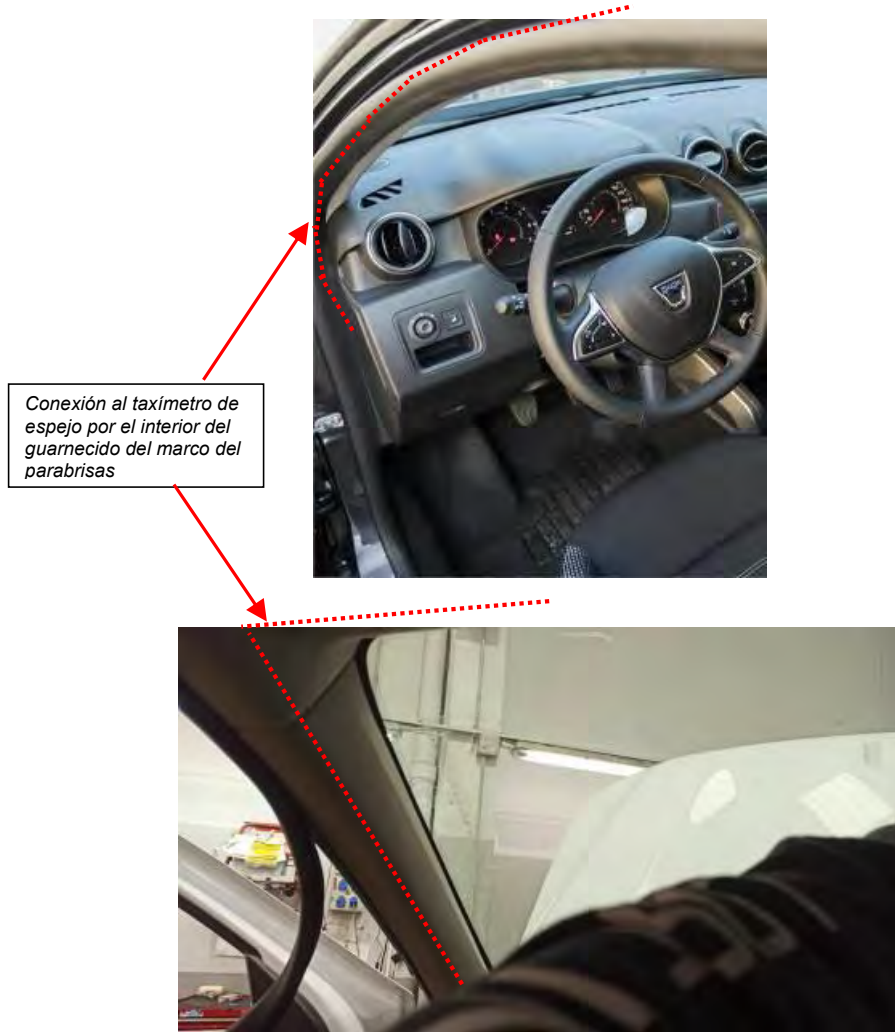
Fig. 4.10 y 4.11. Vista recorrido del cable entre el taxímetro de espejo y la caja adaptadora de señal
