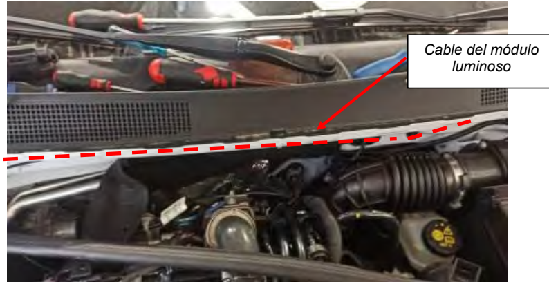
Fig. 6.6. Paso de cable por el compartimento motor
