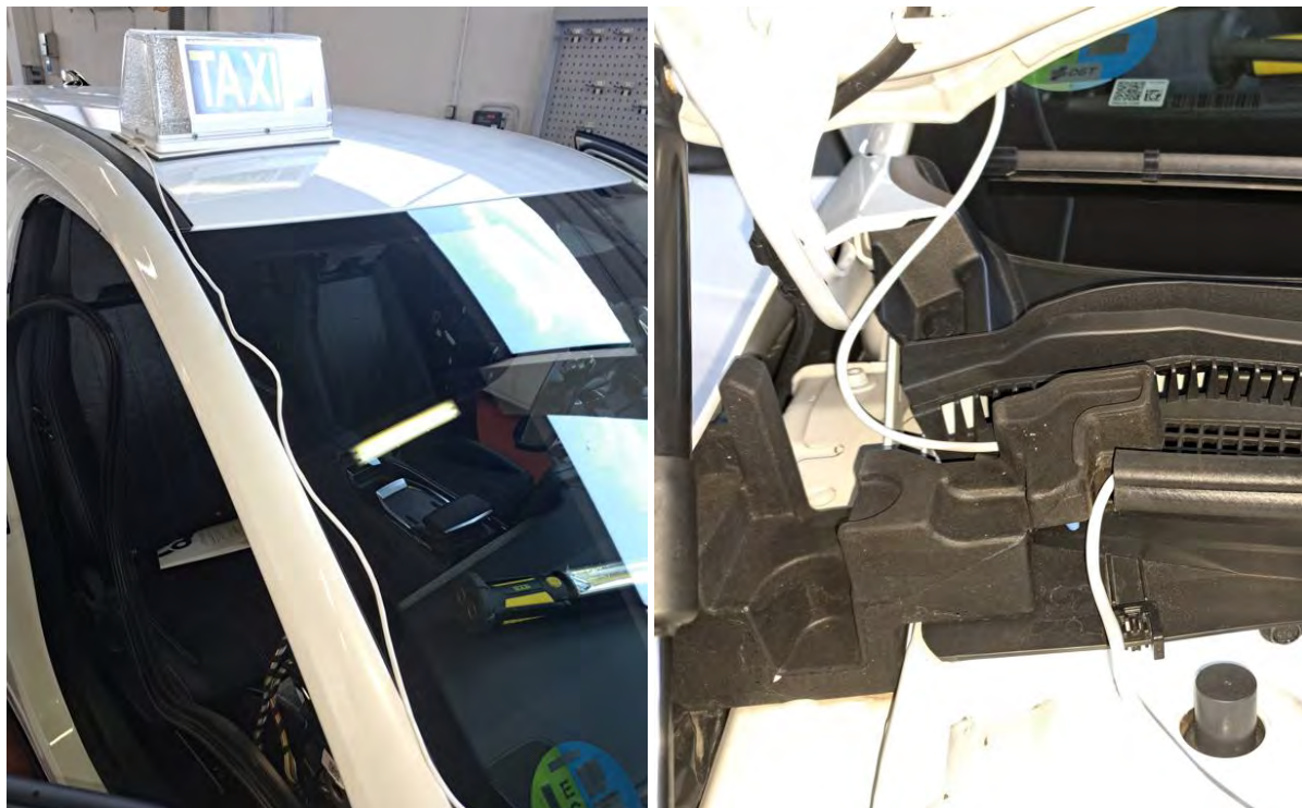
Fig. 6.2.4. Recorrido de los cables por vierteaguas del pilar A derecho.
