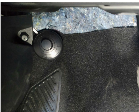
Pulsador de emergencia
