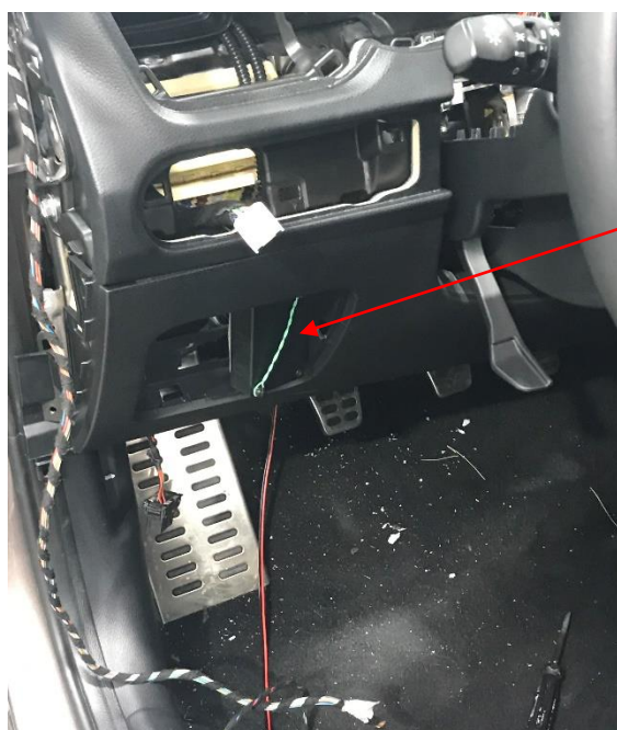
Fig. 1.6. Detalle del paso de manguera blindada al compartimento de la caja de fusibles.
