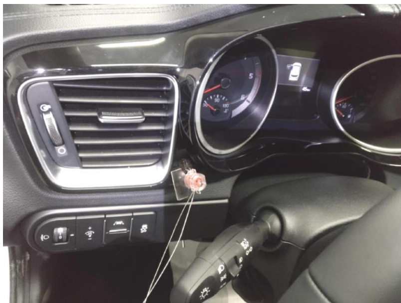
Fig. 1.7. Vista del precintado del cuadro de instrumentos.
