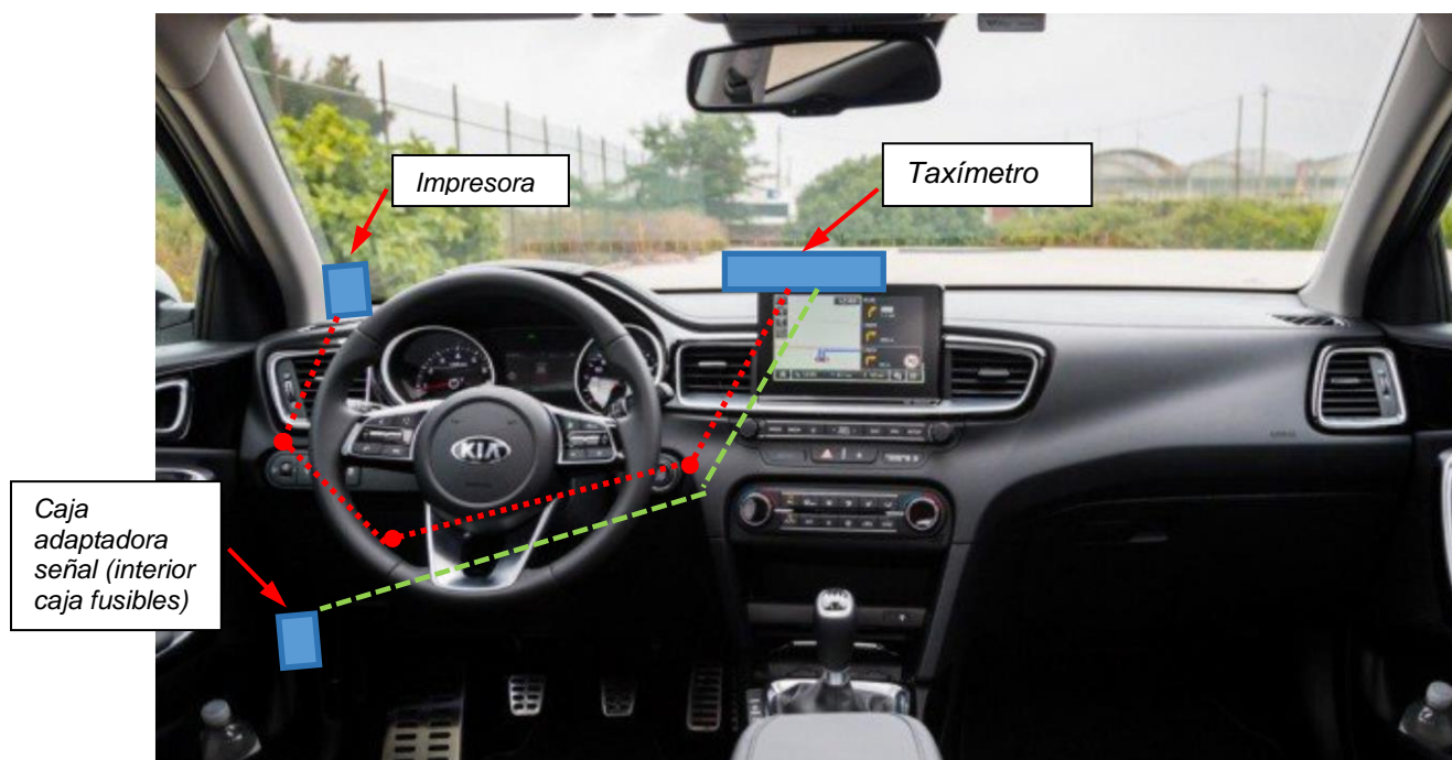
Fig. 4.6. Esquema orientativo del recorrido de las conexiones para taxímetros sobre salpicadero .
