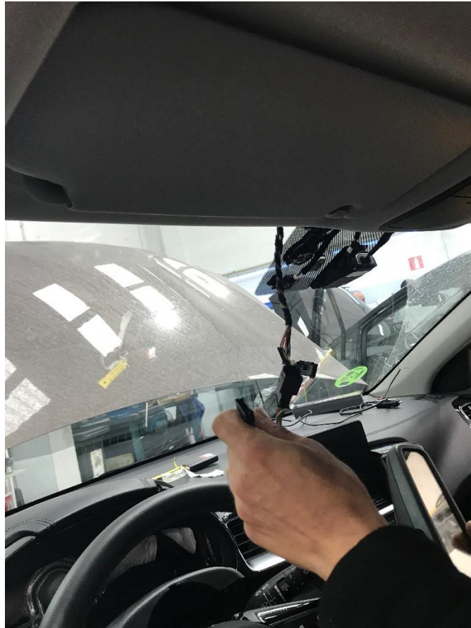
Fig. 4.4. Salida de cables para taxímetro de espejo
