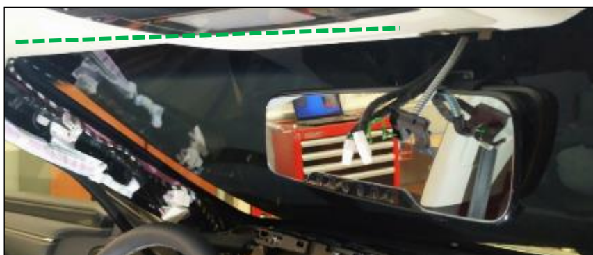
Recorrido del cable del módulo tarifario
