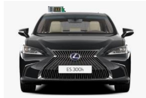
Ubicación módulo tarifario exterior magnético
