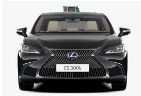
Ubicación módulo tarifario exterior fijo
