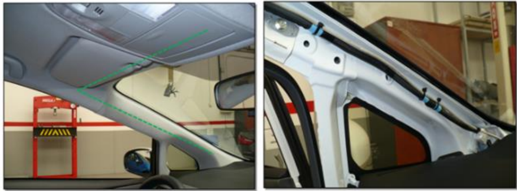
Recorrido del cable del módulo tarifario
