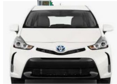
Ubicación módulo tarifario exterior magnético
