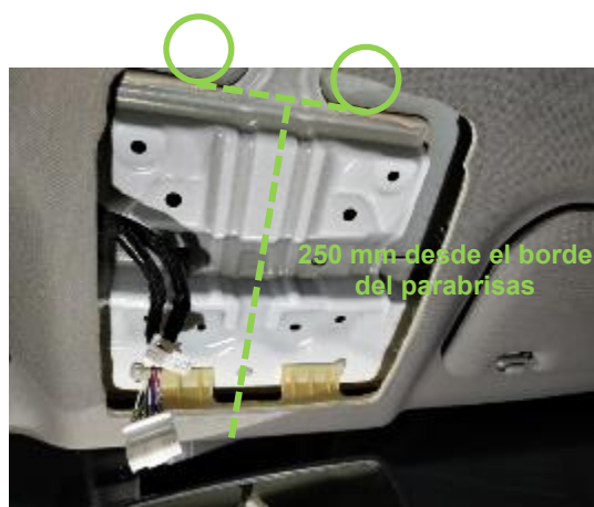
Detalle del hueco de luces de techo y pletina con tornillos y cable de la capilla
