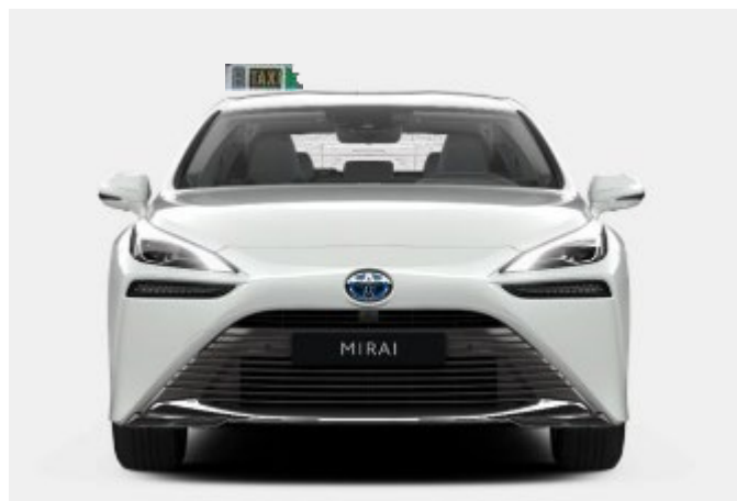
Ubicación módulo tarifario exterior magnético
