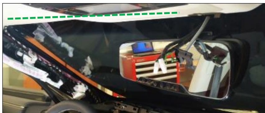
Recorrido del cable del módulo tarifario
