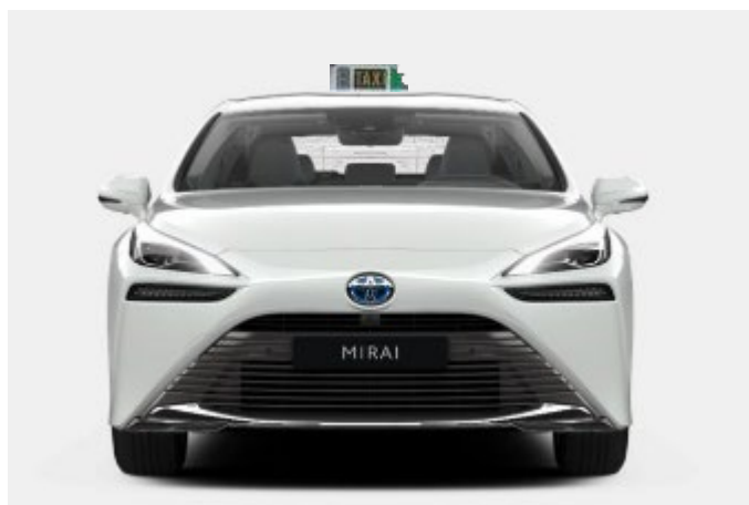
Ubicación módulo tarifario exterior fijo
