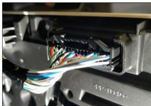
2. Presionar lengüeta superior del conector
