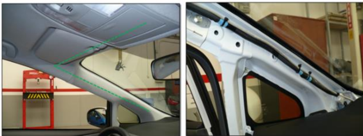
Recorrido del cable del módulo tarifario
