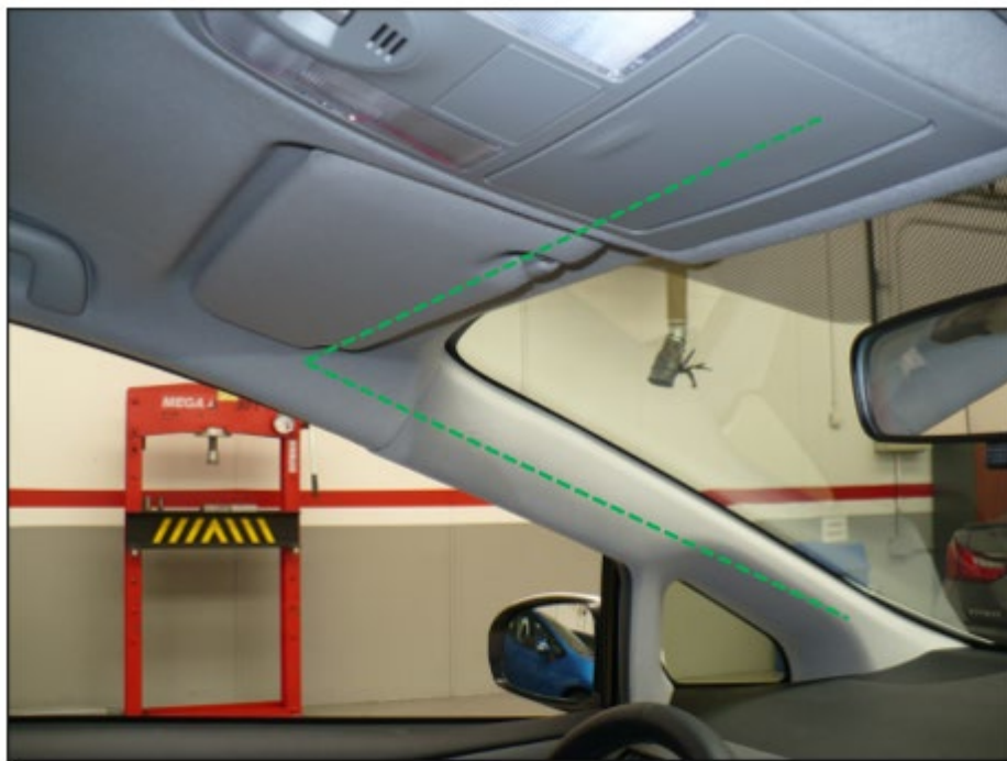
Recorrido de los cables del taxímetro de espejo
