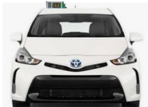
Ubicación módulo tarifario exterior magnético
