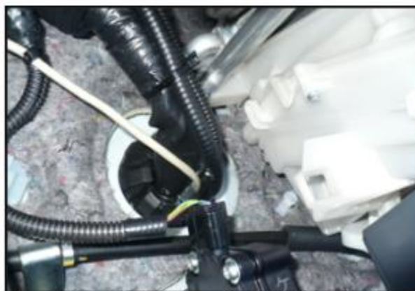
Pasar cables por el pasamuros, sobre el pedal del acelerador
