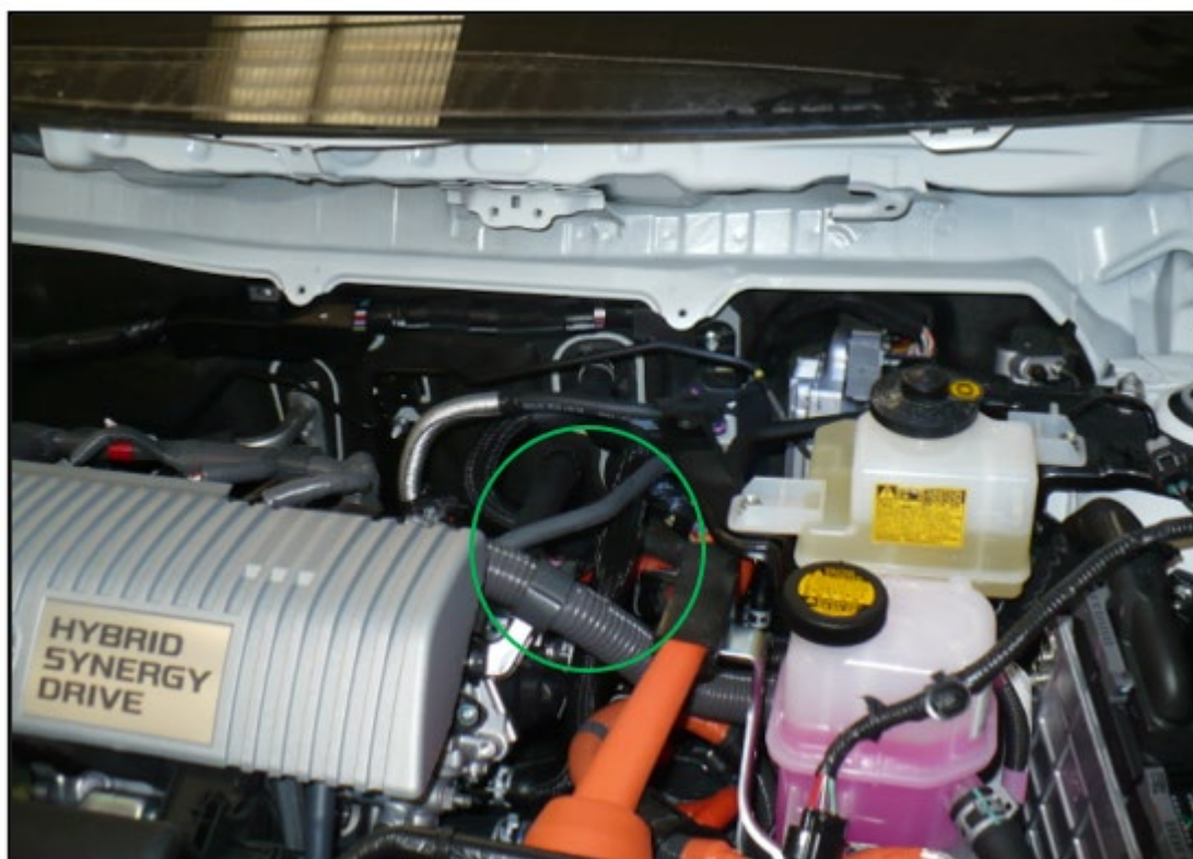
Ubicación pasamuros desde motor
