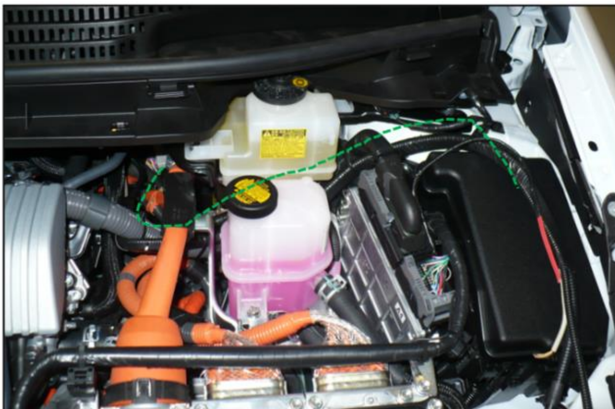
Del pasamuros a la caja de señales
