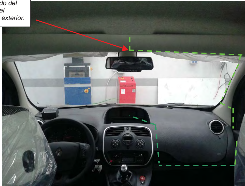
Fig. 9.2. Recorrido del cable del módulo sobre techo.
