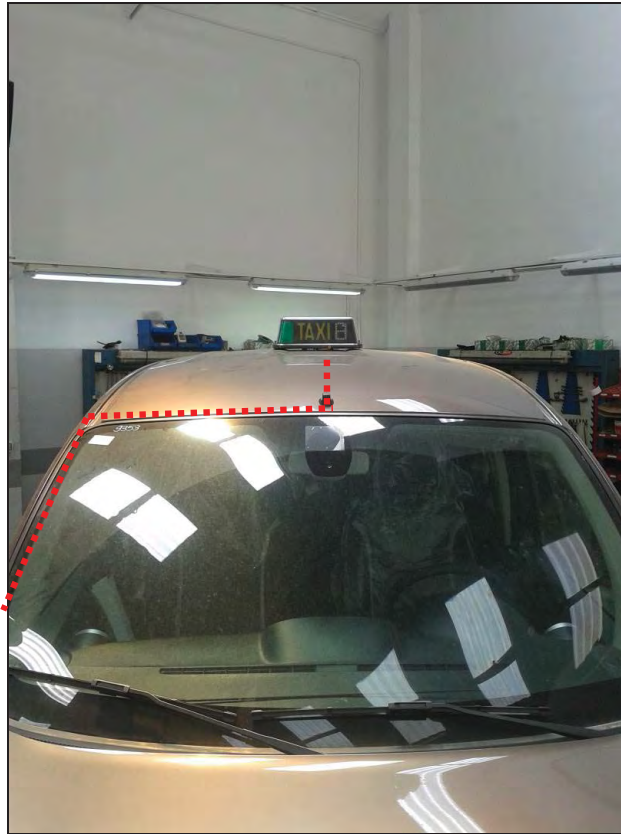
Fig. 9.3. Vista módulo fijado mediante agujeros en el techo
