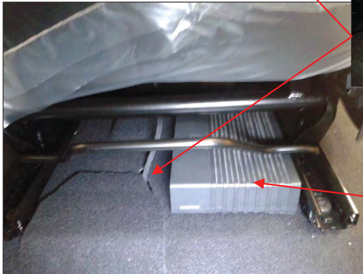
Fig. 10.1. Vista del emplazamiento del módulo de emergencias.
