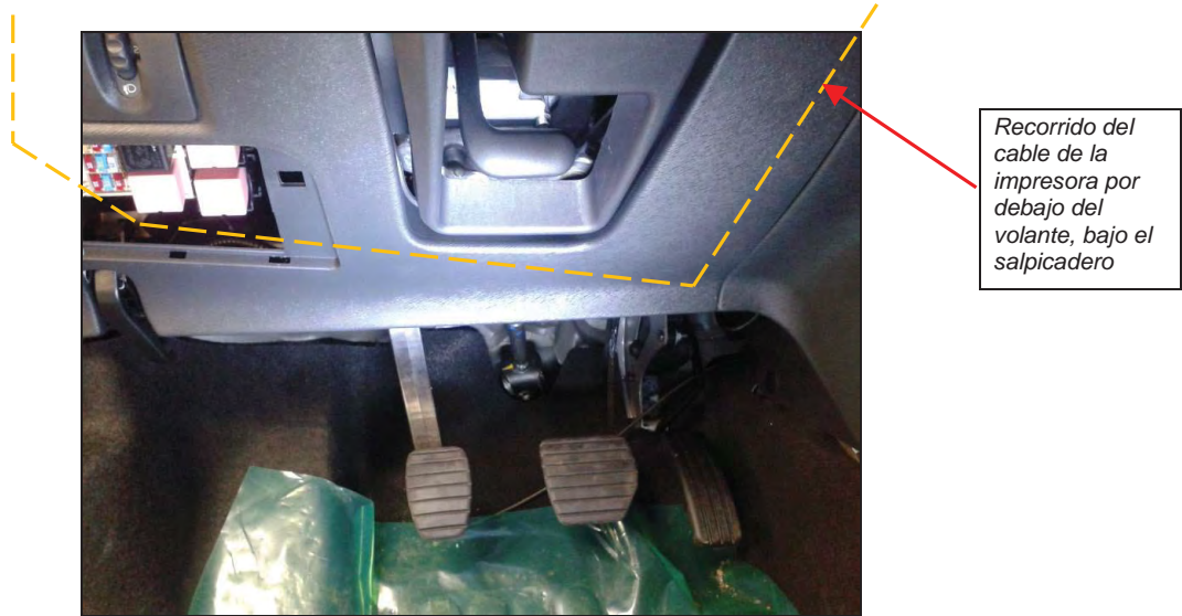
Fig. 8.2. Recorrido del cable de la impresora.
