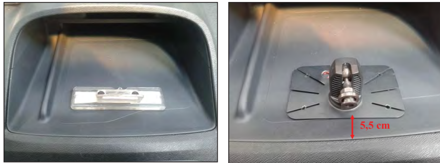
Fig. 5.2. Vistas ejemplo de soportes con cota referenciada al borde delantero del alojamiento central.
