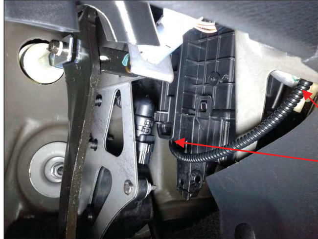
Fig. 5.2. Vista del paso de cables correspondiente a la toma de señal
