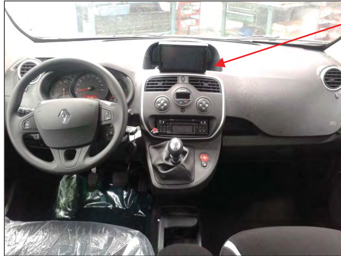
Fig. 5.4. Vista de la disposición del taxímetro con impresora integrada
