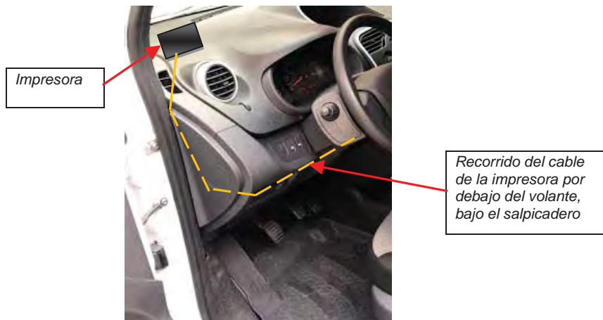
Fig. 8.3. Salida del cable de la impresora.
