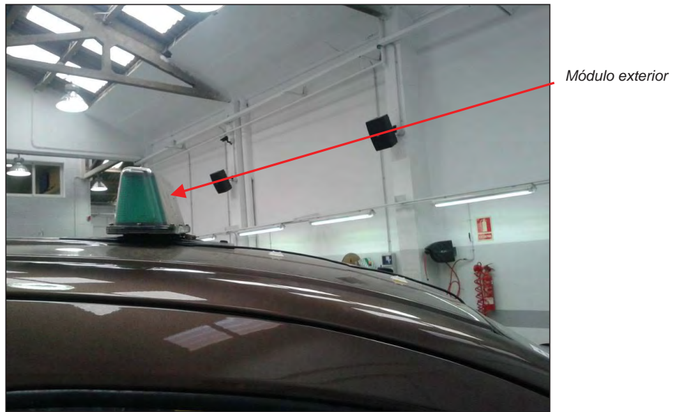
Fig. 9.1. Vista lateral del módulo fijado sobre el techo del vehículo.
