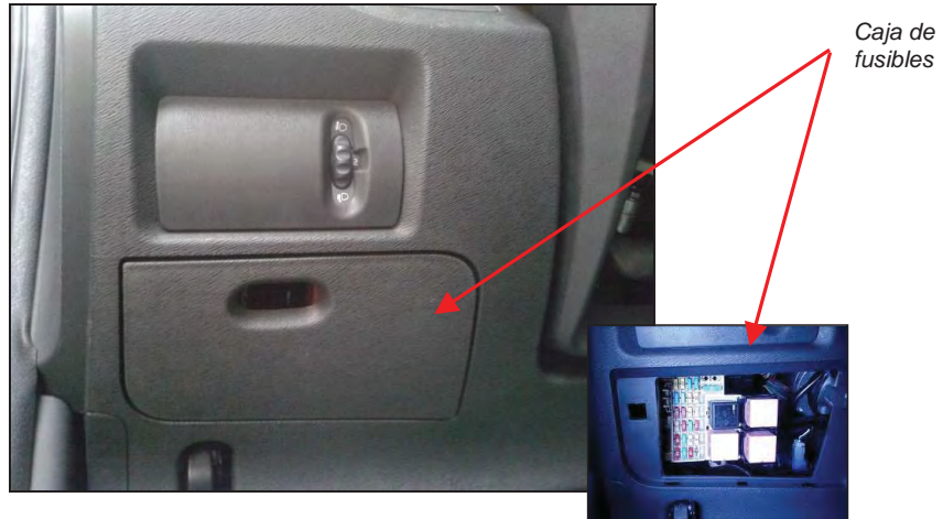
Fig. 2.1. Vista ubicación de la caja de fusibles.
