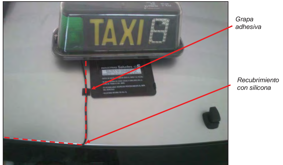
Fig. 9.7. Vista módulo fijado mediante placa imantada
