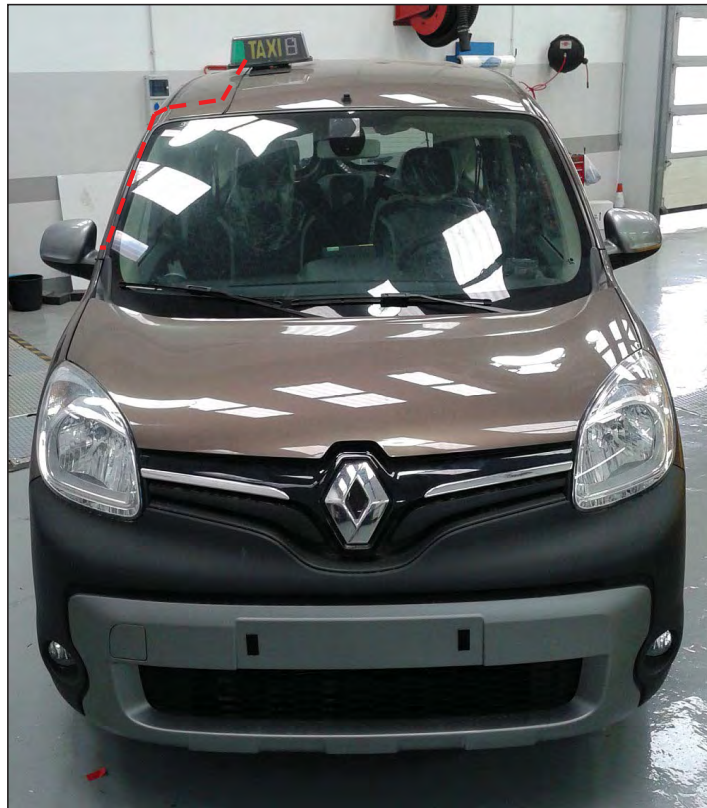
Fig. 9.5. Esquema exterior cableado módulo tarifario
