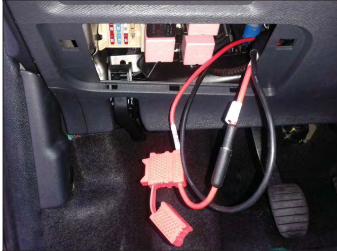
Fig. 2.2. Vista del cable con el fusible.
