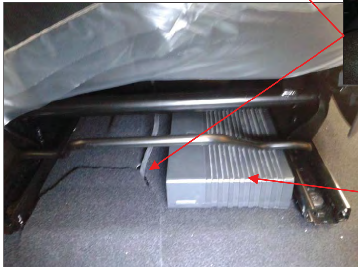
Fig. 3.4. Vistas del emplazamiento del módulo de emergencias.
