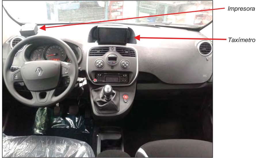
Fig. 5.3. Vistas de la disposición del taxímetro y la impresora.
