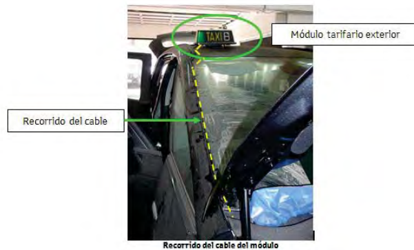
Ejemplos de recorrido del cable por el vierteaguas o por el interior de la puerta derecha.
