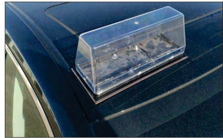
Ejemplos de capilla imantada con base magnética longitudinal y transversal
