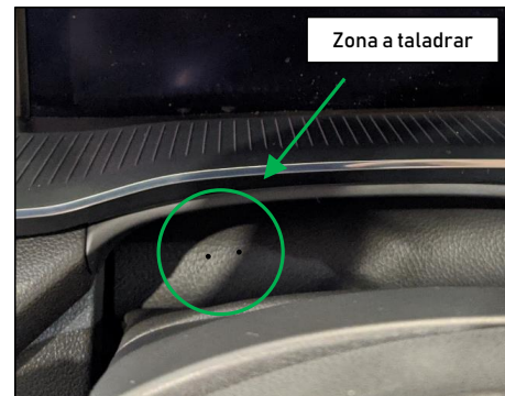
Figura 17. Detalle zona a taladrar.
