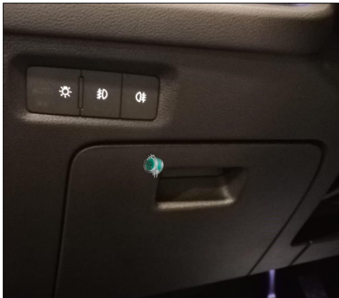
Figura 19. Precinto caja de fusibles.
