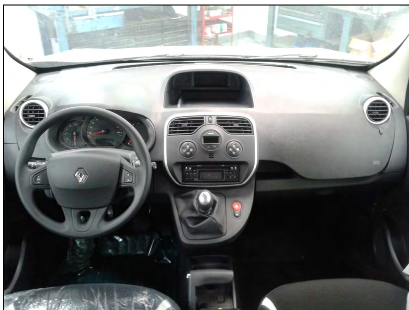
Fig. 3.1. Vista del alojamiento central, donde irá emplazada la caja conversor-adaptador.
