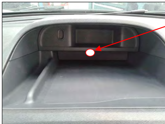
Fig. 5.3. Vista del paso de cables correspondiente a la toma de señal, Alojamiento central.
