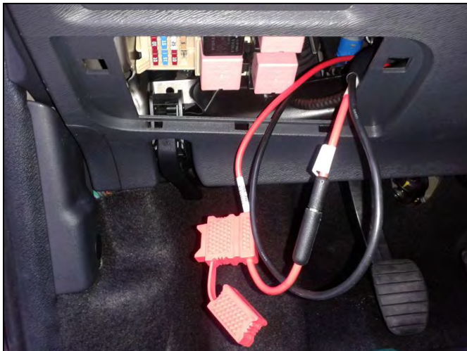
Fig. 2.2. Vista del cable con el fusible.
