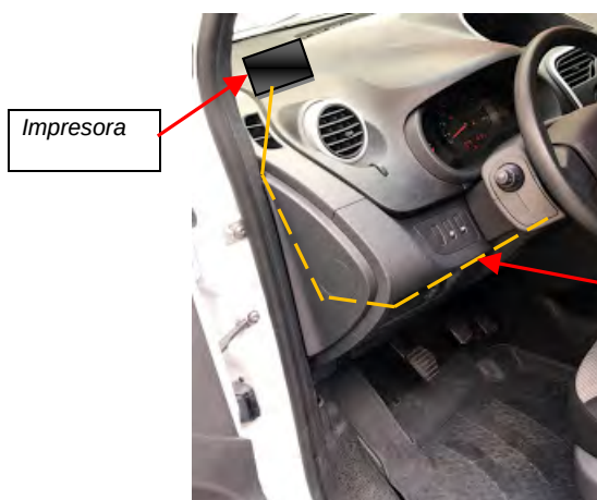
Fig. 8.3. Salida del cable de la impresora.
