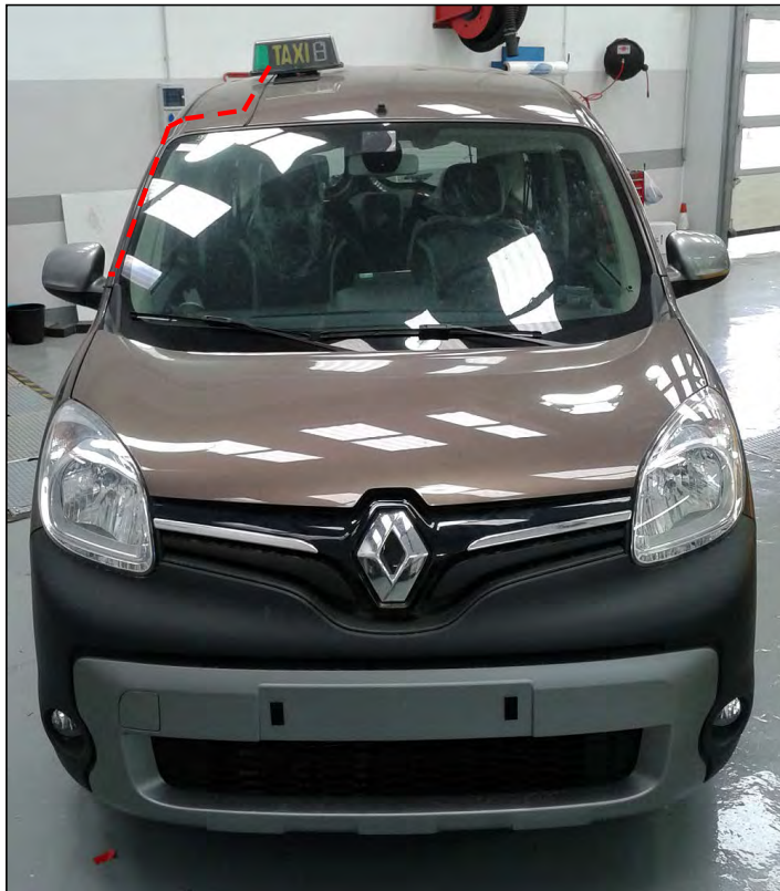
Fig. 9.5. Esquema exterior cableado módulo tarifario
