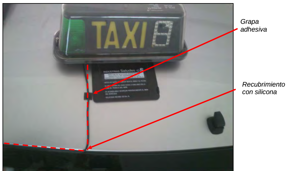
Fig. 9.7. Vista módulo fijado mediante placa imantada
