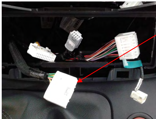
Fig. 3.2. Vista detalle del conector extraído.
