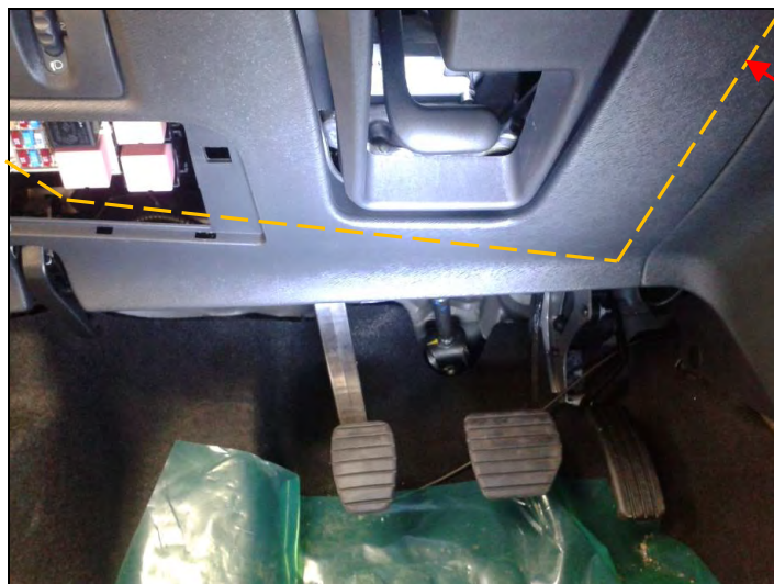
Fig. 8.2. Recorrido del cable de la impresora.
