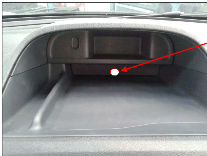
Fig. 3.2. Vista donde se muestra dónde se debe realizar el orificio.
