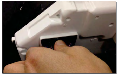
2. Presionar lengüeta superior del conector
