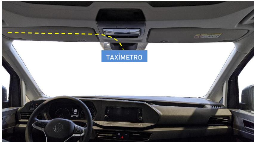
Figura 30. Trazado del cable del módulo tarifario
