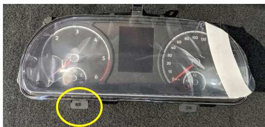
Figura 14. Ubicación tornillo a sustituir.
