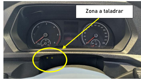
Figura 17. Detalle zona a taladrar.
