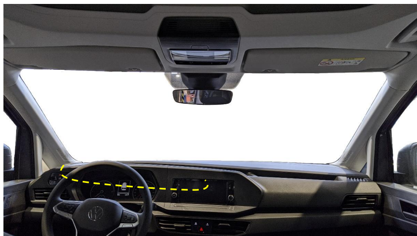
Figura 24. Trazado de la manguera con módulo tarifario en la izquierda.
