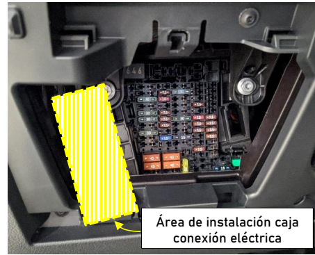
Figura 4. Área de instalación caja conexión eléctrica.
