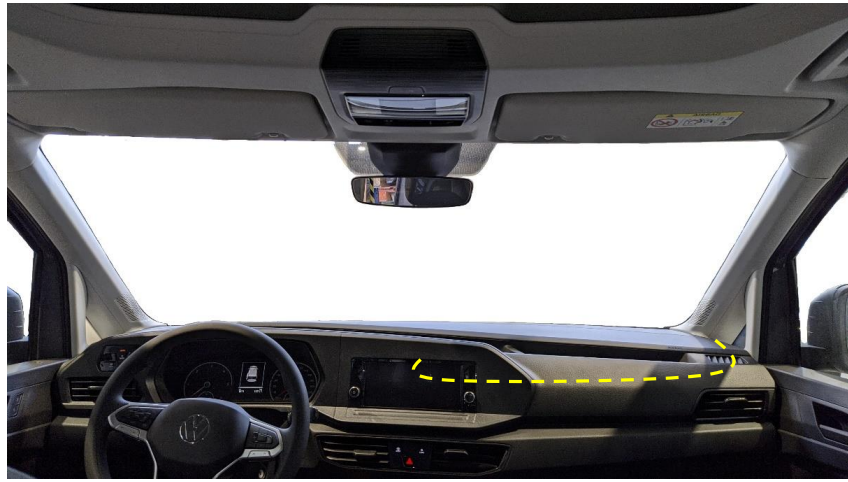
Figura 23. Trazado de la manguera con módulo tarifario en la derecha.
