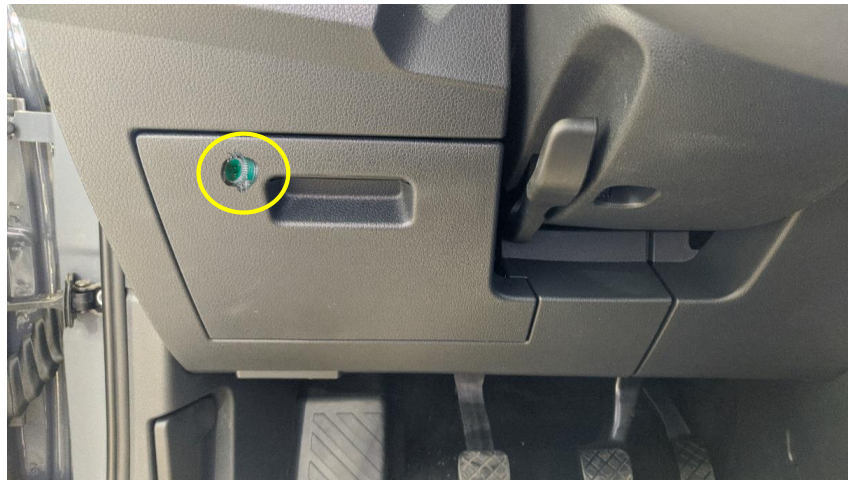
Figura 19. Precinto caja de fusibles.
