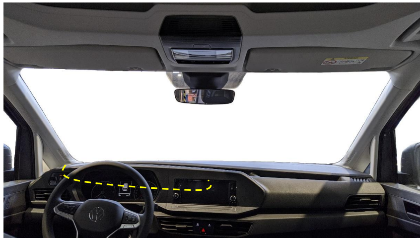
Figura 27. Recorrido cable impresora.
