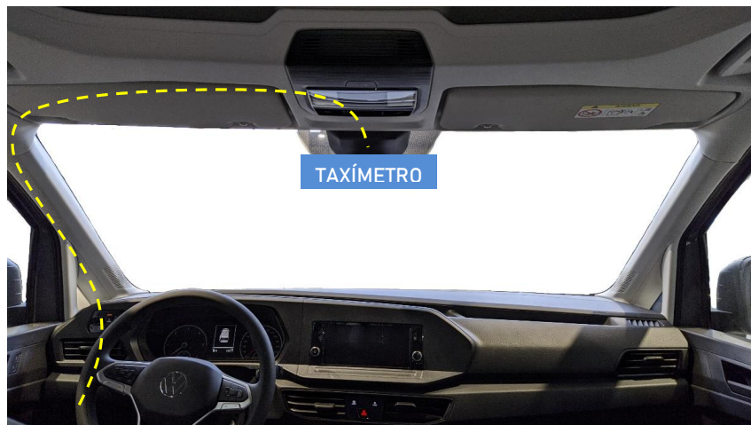
Figura 29. Recorrido de la manguera del taxímetro.
