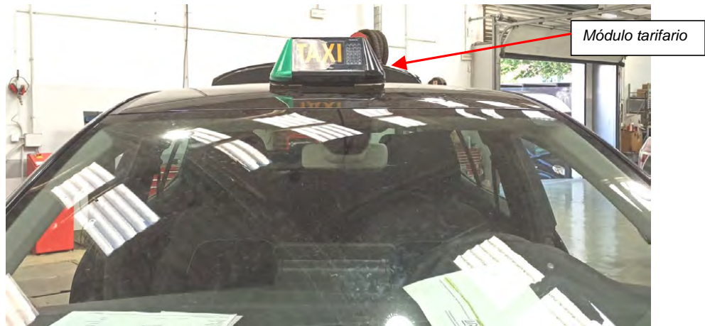
Fig. 6.1. Vista frontal ejemplo módulo centrado atornillado
