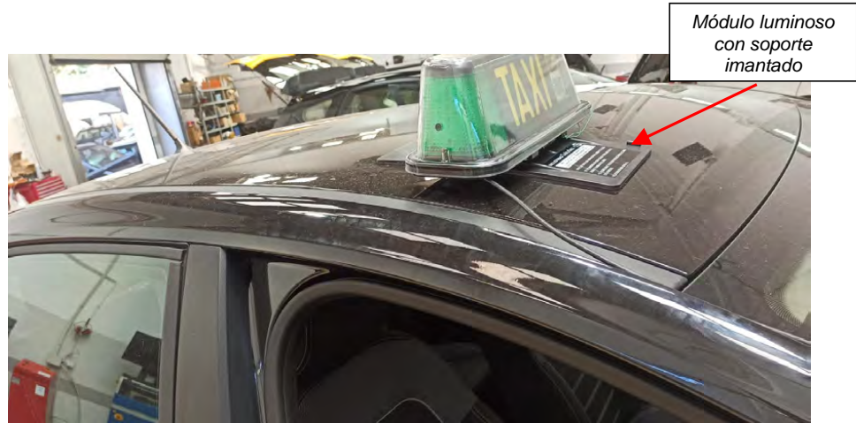
Fig. 6.4. Vista del módulo luminoso desplazado sobre soporte imantado
