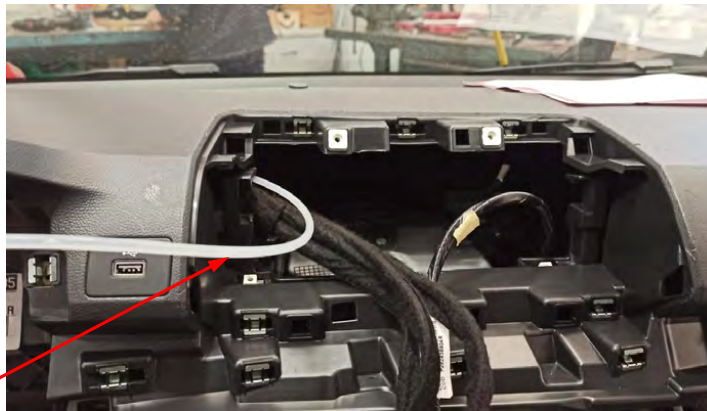
Fig. 4.2. Vista del paso de cables por el interior del salpicadero
