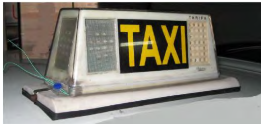
Fig. 6.3. Vista del módulo y su precinto
