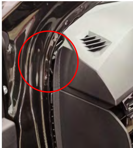
Fig. 4.5. Zona de paso del cableado
