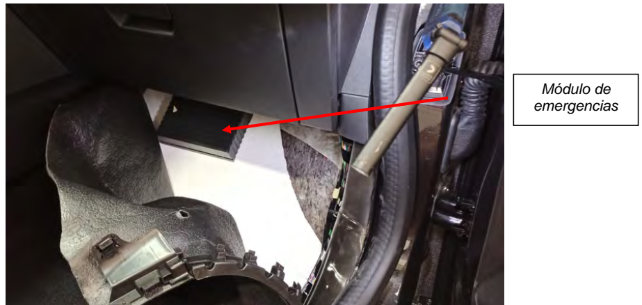
Fig. 7.2. Vista del emplazamiento del módulo de emergencias bajo el guardafango.
