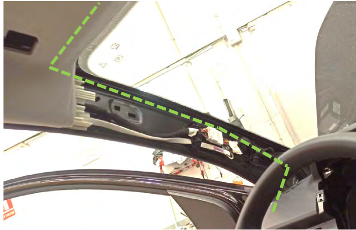
Fig. 4.6. Recorrido de los cables por el interior del guarnecido del marco del parabrisas.
