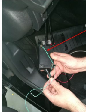
Precintado caja adpatadora de señal
