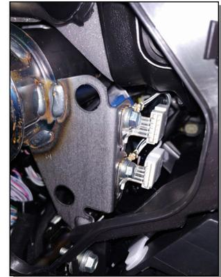
Como alternativa a la toma de alimentaciones en el conector G17 del cuadro de instrumentos, estas podrían tomarse de la caja de fusibles de habitáculo bajo volante mediante un conector de tipo fusible y de la manera que muestra la imagen:
