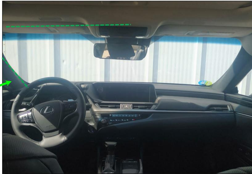
Dado que en este vehículo solamente se admiten como taxímetros los modelos que van integrados en el espejo retrovisor interior, los cableados necesarios irán por el lado izquierdo del guarnecido del techo desde el plafón de luces y bajarán por el pilar "A" del lado del conductor hasta el cuadro de instrumentos / caja de conexiones bajo volante y demás elementos. En función del tipo de instalación, podría hacerse también por el lado derecho.
