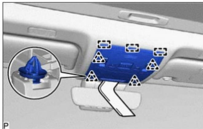
Desmontaje plafón luces del techo
