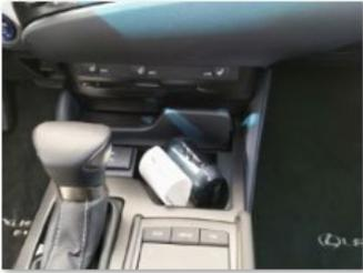
El cable de conexión se llevará por detrás del guarnecido del volante, y bajará hasta la consola central. Retirando el embellecedor lateral de la consola inferior, se pasará el cable hasta el hueco de ubicación, y se perforará un orificio para que pasen los cables hasta la impresora.
