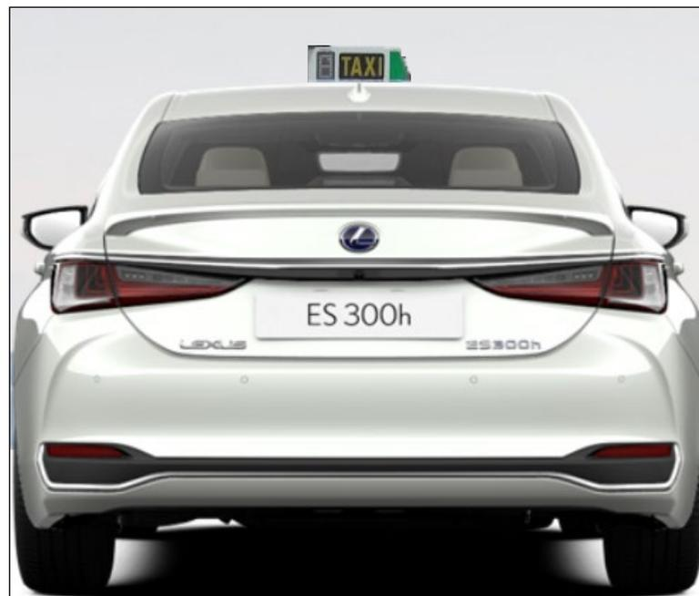
La capilla se colocará centrada en el plano transversal del vehículo aproximadamente a 70 mm del borde del parabrisas (130 mm aprox. de su punto central).
