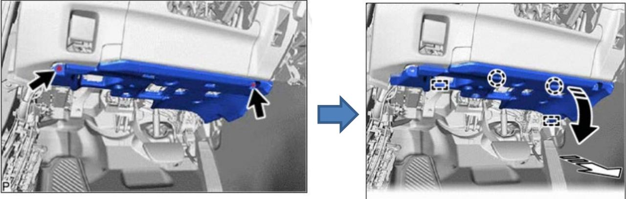
4 Extraer el conjunto inferior de la moldura del panel de instrumentos.
