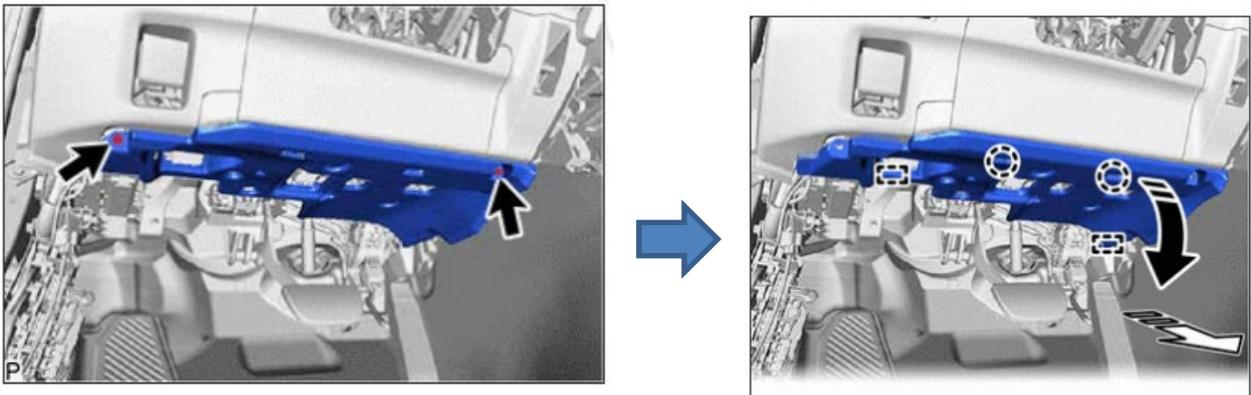
7 Extraer el conjunto inferior de la moldura del panel de instrumentos.
