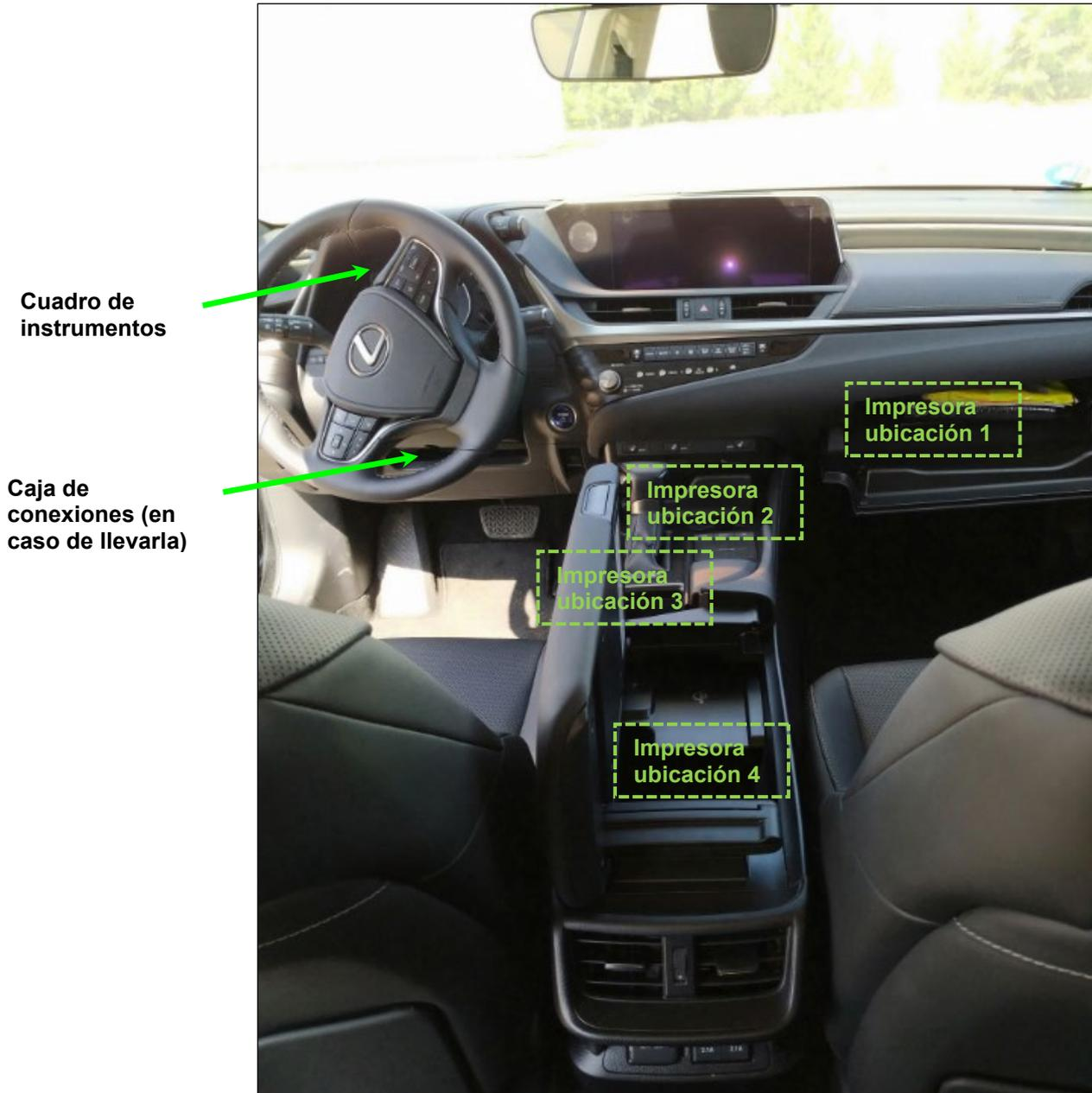
En cualquiera de estas ubicaciones, los cables de conexión necesarios para la impresora se llevarán por el interior de los guarnecidos, desde el punto de origen (caja de conexiones o conector cuadro de instrumentos) hasta dicha impresora.
