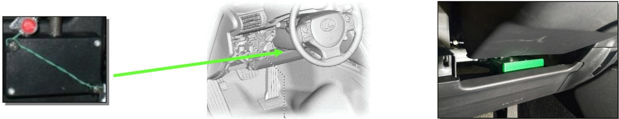
**Nota importante:** La ubicación indicada es la más idónea en base a la facilidad de acceso / inspección. No obstante el instalador autorizado podrá reubicar la caja de conexiones en el área bajo el panel de instrumentos bien en la zona izquierda, o tras la guantera del lado derecho si por razones de cableados o conexiones no fuera posible instalarla bajo el volante, y siempre que no interfiera en los sistemas del vehículo (airbag, dirección, calefacción).
