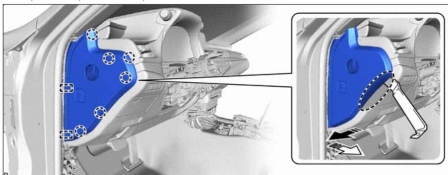
3 Extraer la cubierta inferior del panel de instrumentos N° 1.
