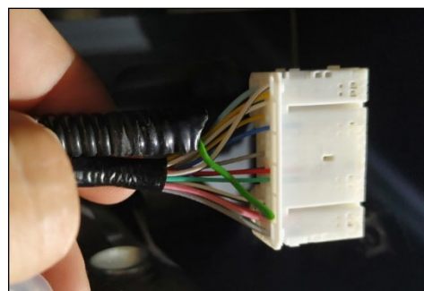
4.- Soldar cable taxímetro a la señal de velocidad
