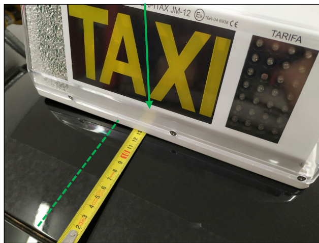
Ubicación del módulo luminoso
