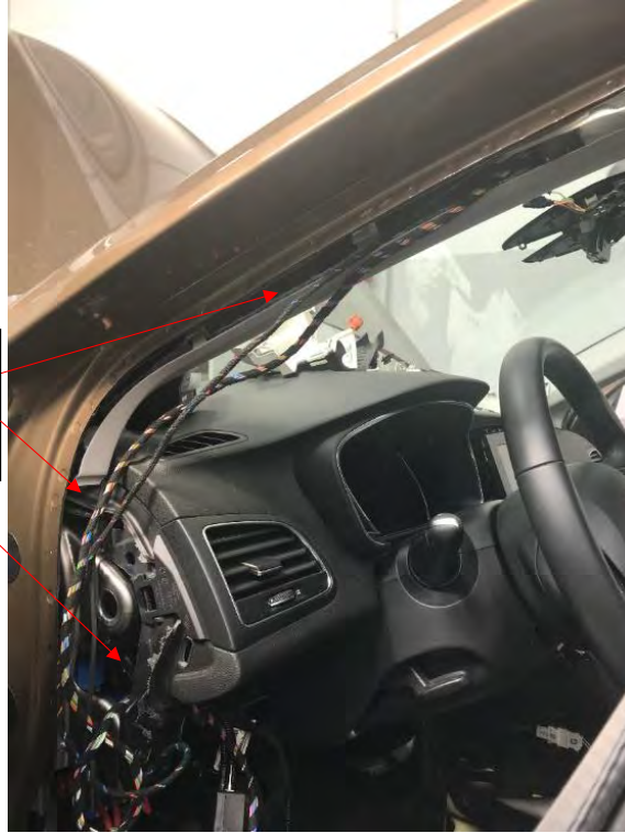
Fig. 4.6. Entrada de cables al interior del salpicadero.
