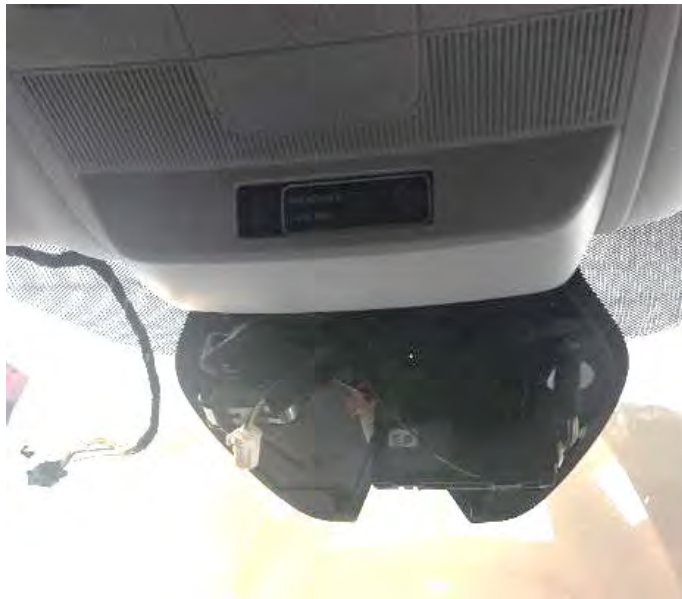
Fig. 5.3. Vista de punto de anclaje del soporte del espejo.
