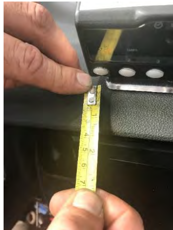
Fig. 5.2. Separación taxímetro a borde salpicadero.
