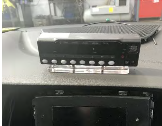
Fig. 5.1. Ubicación taxímetro consola sobre salpicadero.
