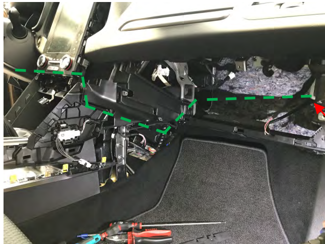
Fig. 3.3. Detalle paso cables de alimentación
