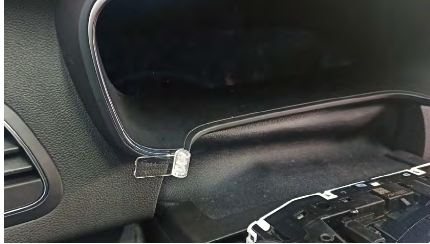
Fig. 2.7. Vista final del montaje precintado
