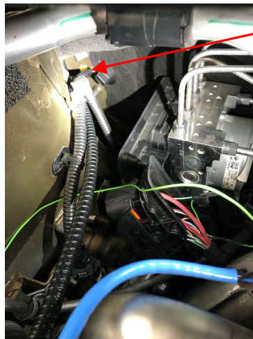
Fig. 3.2. Detalle pasamuros junto al módulo ABS/ESP, vista compartimento motor
