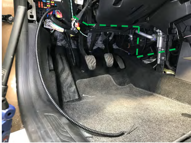
Fig. 3.4. Detalle recorrido cables de alimentación bajo el salpicadero hasta el compartimento de la caja de fusibles
