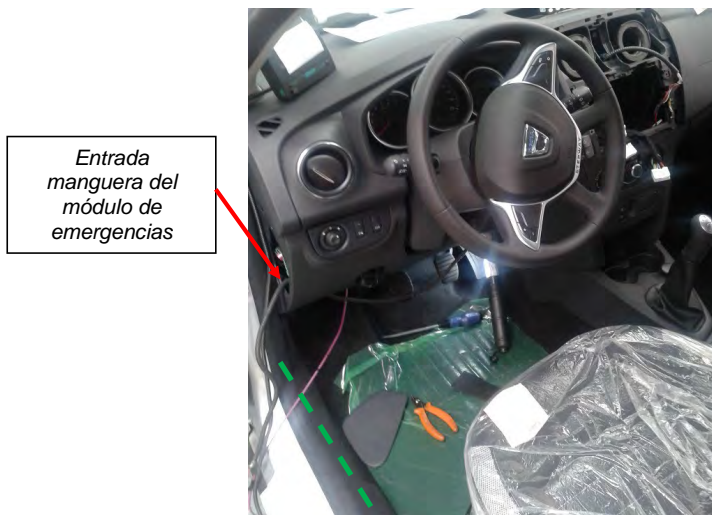
Fig. 7.2. Recorrido de la conexión módulo de emergencias.
