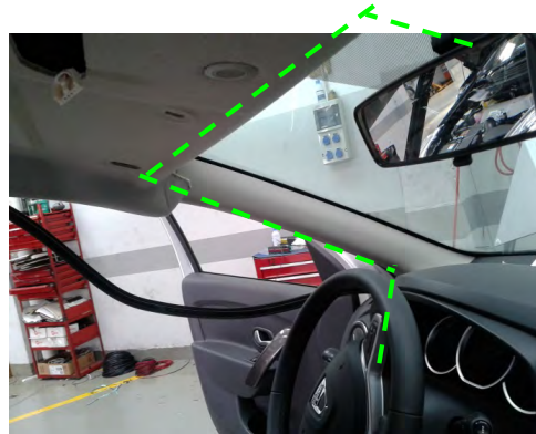
Fig. 4.9. Vista recorrido del cable del taxímetro de espejo y la caja adaptadora de señal
