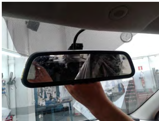
Fig. 4.6. Vista del taxímetro de espejo sobre soporte original del vehículo
