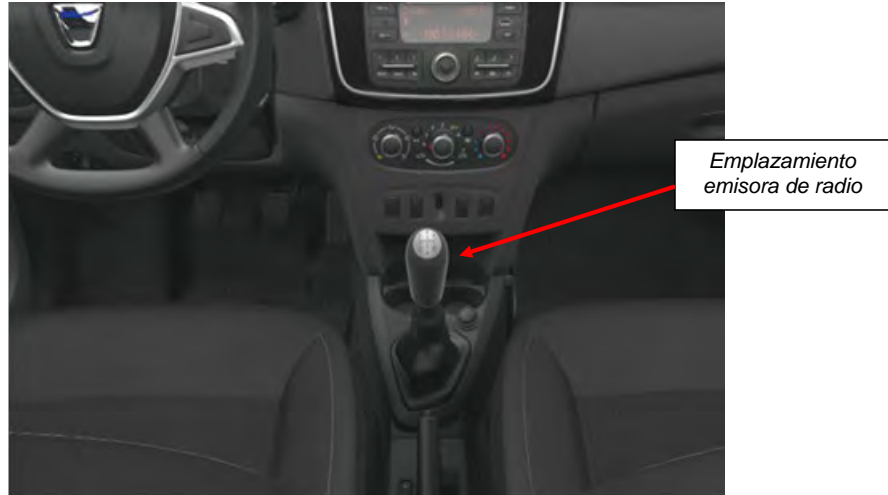
Fig. 7.2. Vista del emplazamiento previsto de la emisora de radio.
