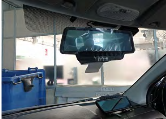
Fig. 4.7 y 4.8. Vistas del taxímetro de espejo con impresora sobre soporte propio.
