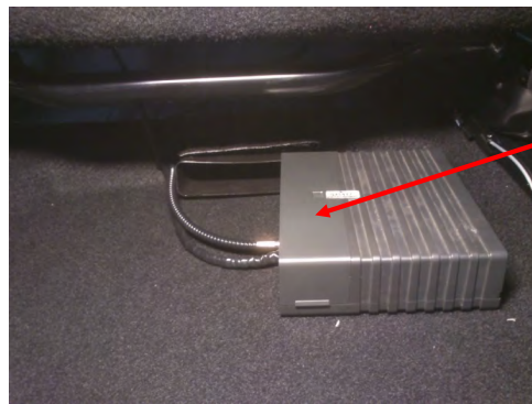
Fig. 7.1. Vista del emplazamiento del módulo de emergencias.
