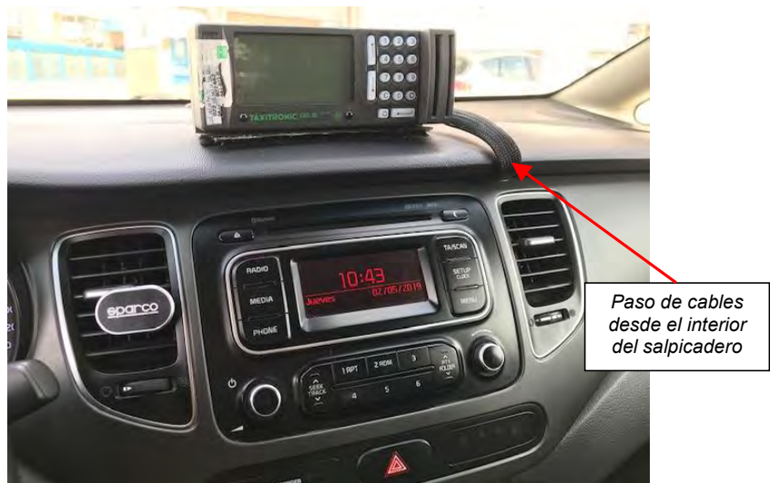
Fig. 5.1. Zona para el emplazamiento de taxímetro sobre salpicadero
