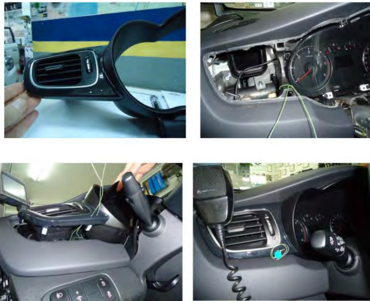
Fig. 1.7-1.8.1.9-1.10. Secuencia de precintado del cuadro de instrumentos!
