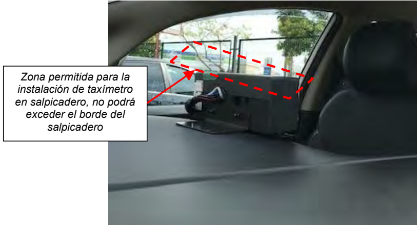
Fig. 5.3. Vista posterior de la ubicaci3n del taximetro y del precintado (ej. de precinto de etiqueta autodestructible)
