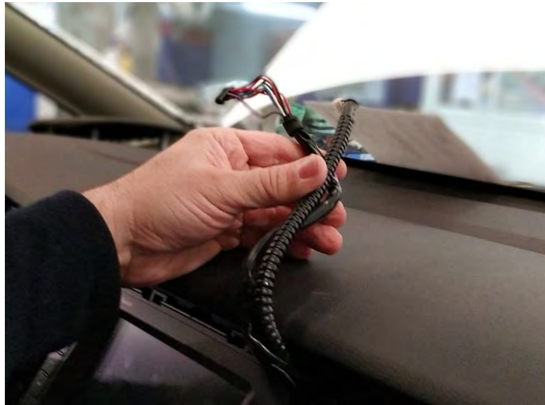
Fig. 3.1. Detalle de la manguera con señal de velocidad y del cable de alimentación
