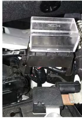
Fig. 2.4. Vista de la ubicación del portafusibles
