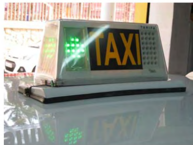
Fig. 8.1.1 Vista lateral del módulo y su precinto
