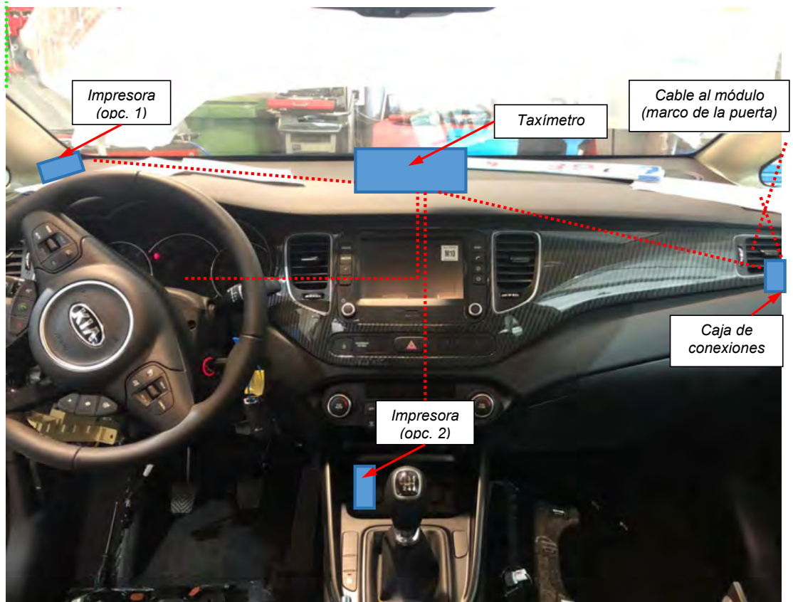
Fig. 4.1. Vista orientativa del paso de cables de conexión
