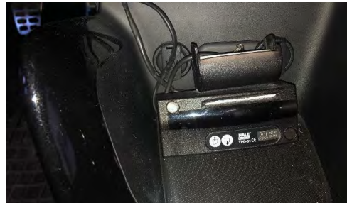
Fig. 6.2. Ubicación y conexión de la impresora en portaobjetos central (recomendado sólo si no se va a llevar emisora)
