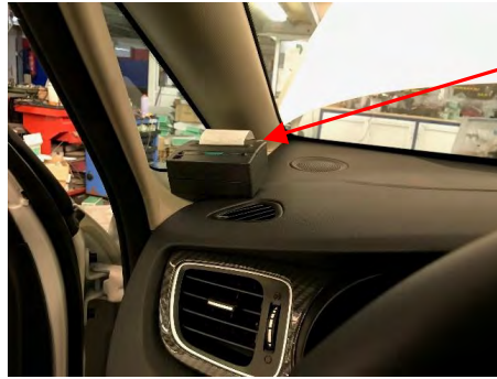
Fig. 6.1. Ubicación de impresora sobre salpicadero
