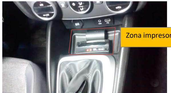
En la figura de la izquierda fijamos la impresora en la zona izquierda del salpicadero bien con soporte o a través de cinta de doble cara.
