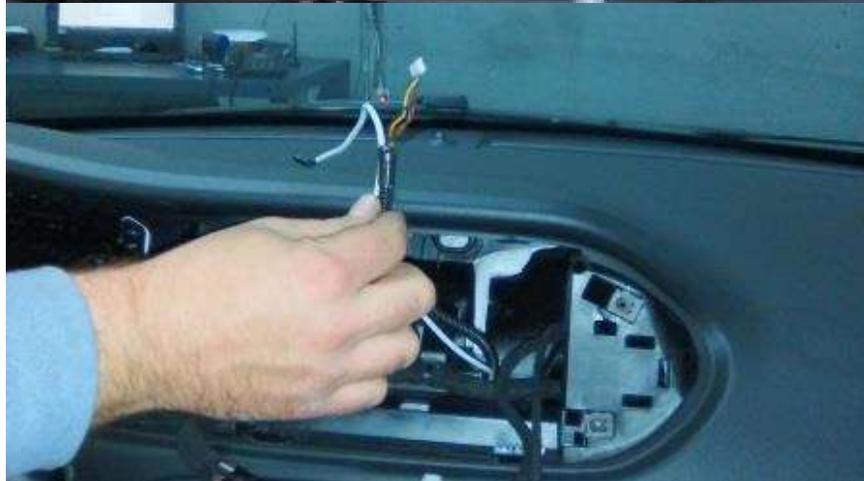
Desmontaje del Techo para el montaje de la capilla o taxímetro de espejo
