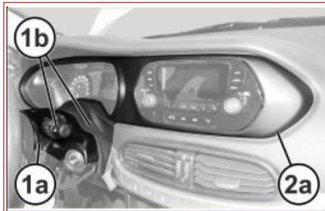
1. Soltar y apartar el revestimiento superior de la caña de dirección (1a) y liberarlo de las palancas de mando (1b).
