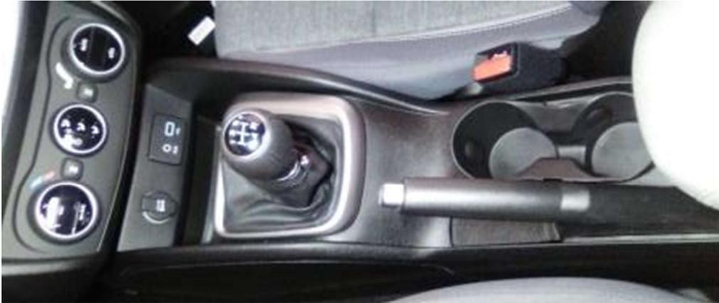
Desmontamos tapas laterales delanteras, solo lleva grapas.
