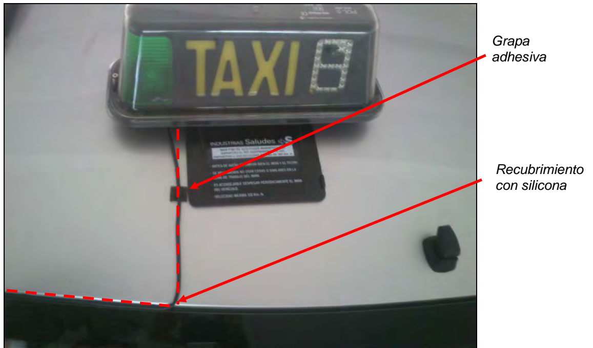
Fig. 9.7. Vista módulo fijado mediante placa imantada
