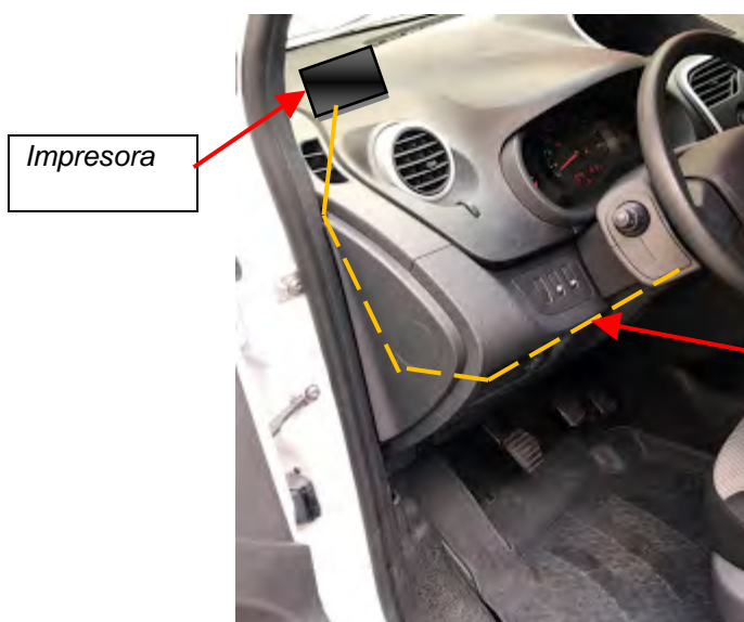
Fig. 8.3. Salida del cable de la impresora.
