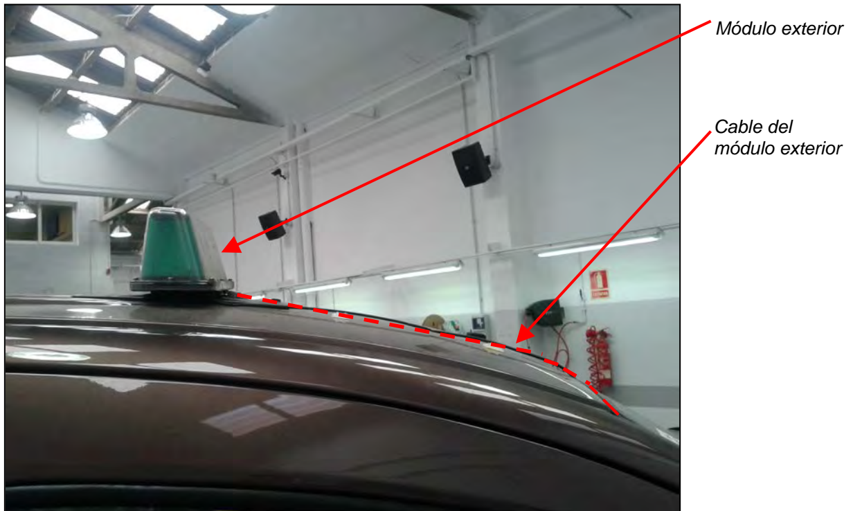
Fig. 9.4. Vista lateral del módulo con el cable.
