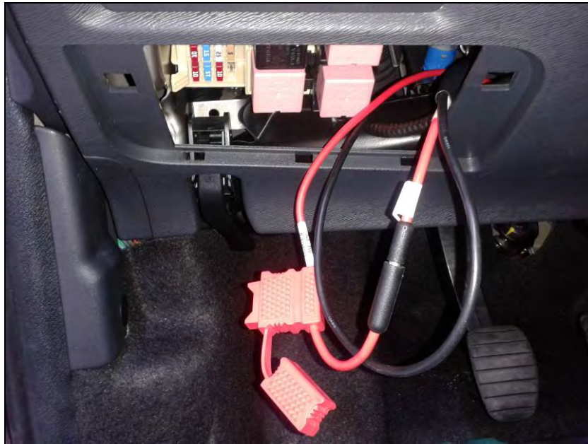
Fig. 2.2. Vista del cable con el fusible.
