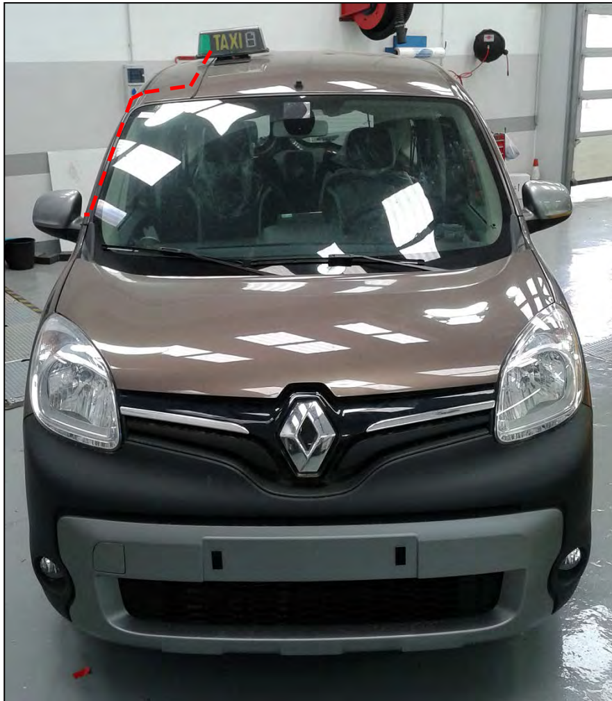
Fig. 9.5. Esquema exterior cableado módulo tarifario
