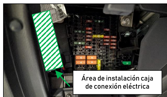
Figura 4. Área de instalación caja conexión eléctrica.
