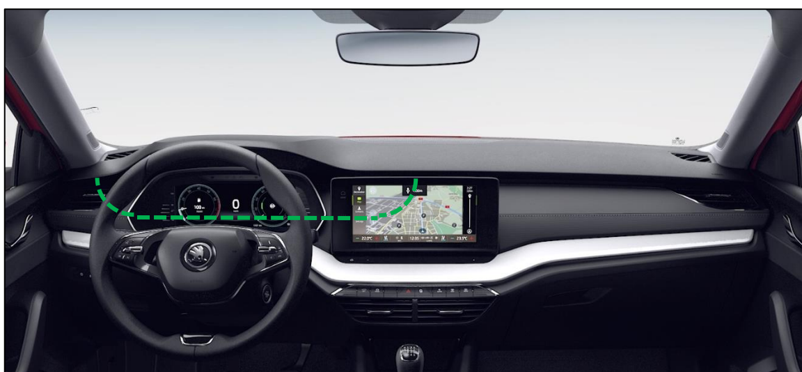
Figura 24. Trazado de la manguera con módulo tarifario en la izquierda.
