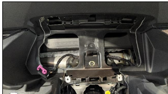
Figura 7. Cuadro de instrumentos desmontado.
