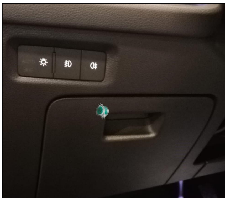
Figura 19. Precinto caja de fusibles.
