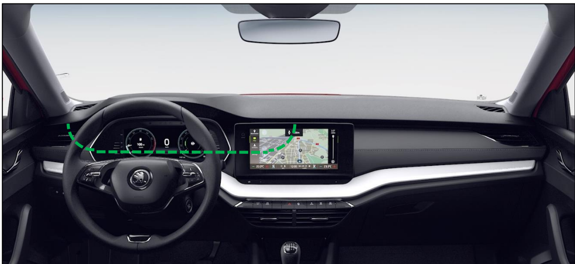
Figura 27. Recorrido cable impresora.
