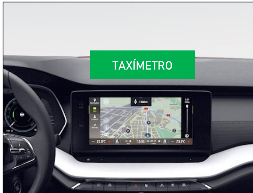
Figura 26. Área de instalación del taxímetro.
