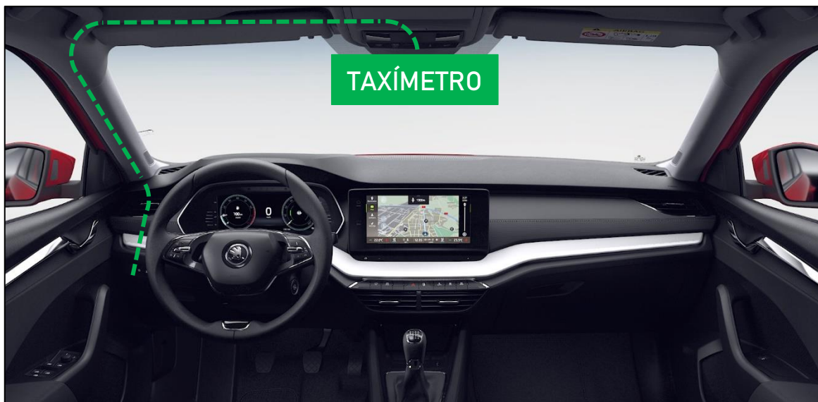
Figura 29. Recorrido de la manguera del taxímetro.
