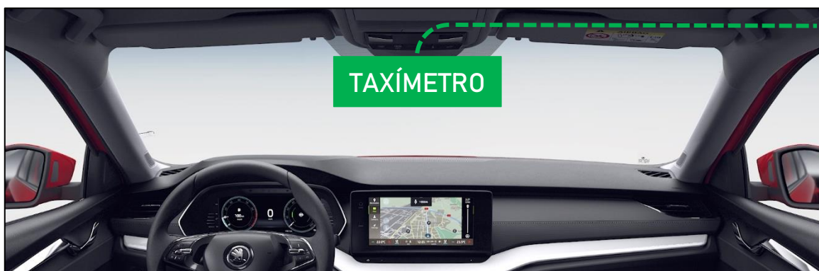
Figura 31. Trazado del cable del módulo tarifario
