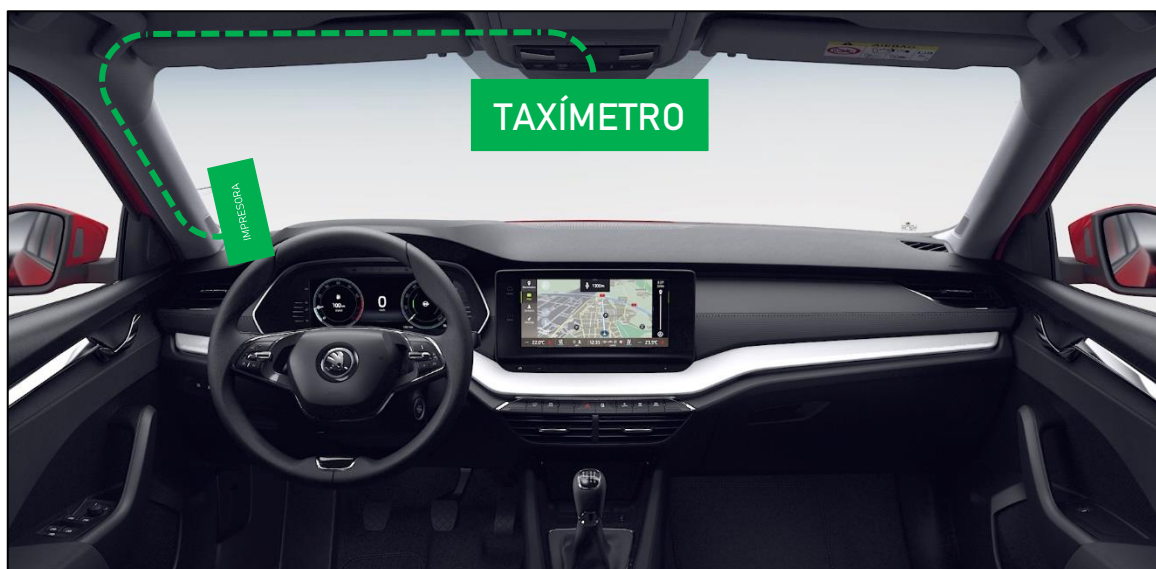
Figura 33. Recorrido cable de la impresora.
