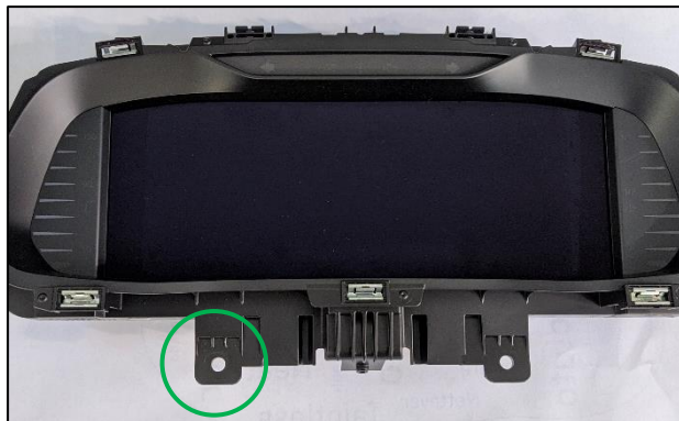
Figura 14. Ubicación tornillo a sustituir.
