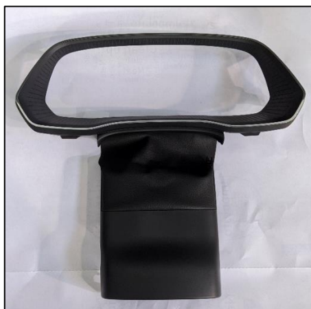
Figura 16. Embellecedor cuadro de instrumentos.
