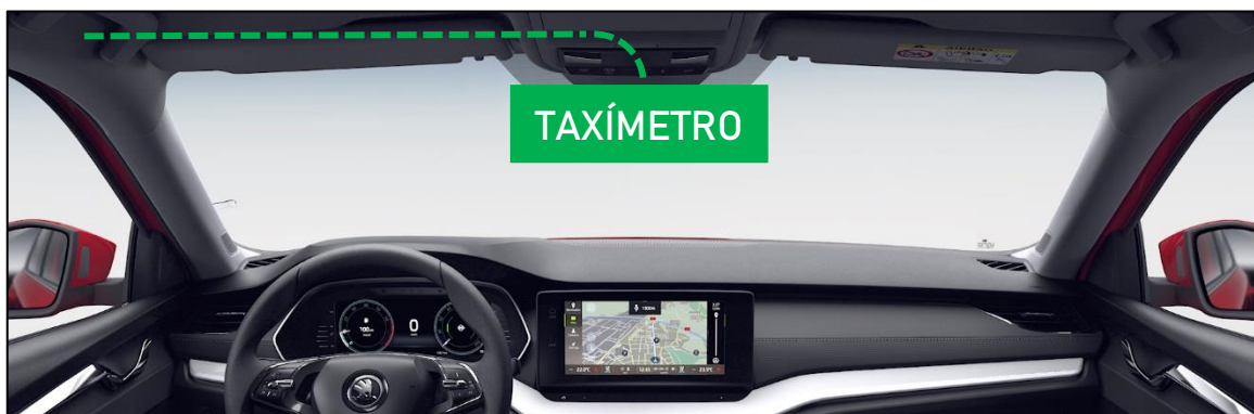
Figura 30. Trazado del cable del módulo tarifario
