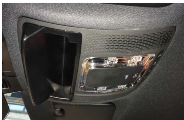
Preequipo para montaje de taxímetro en techo (336)
