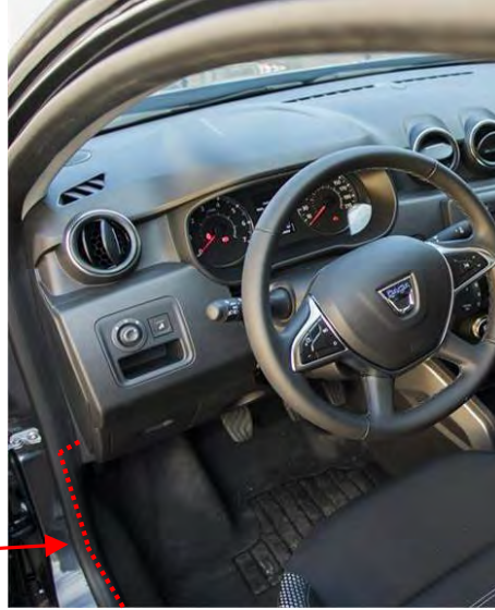
Fig. 7.3. Vista del recorrido de las conexiones del módulo de emergencias.
