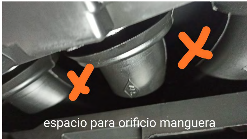
Fig. 4.3. Vista de las zonas de paso entre las toberas de los aireadores
