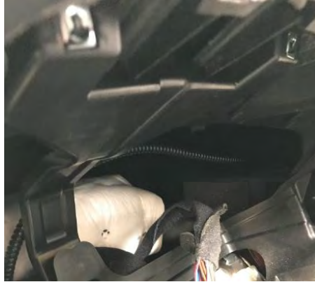
Fig. 4.2. Paso de cables por dentro del salpicadero
