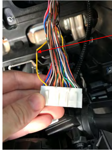
Fig. 1.3. Detalle de la conexión del cable de señal para el taxímetro con el cable del pin 18
