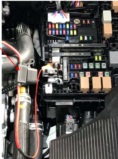
Fig. 2.1. Vista de las conexiones de alimentación a batería.
