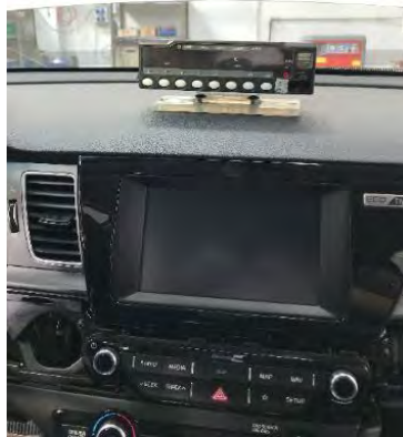
Fig. 4.3 y 4.4. Ubicación del taxímetro de consola
