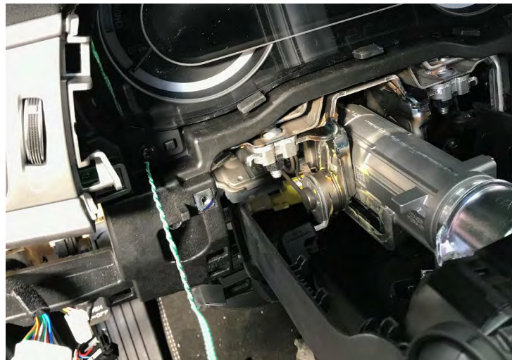
Fig. 1.6. Precintado del cuadro de instrumentos
