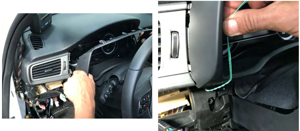
Fig. 1.7 y 1.8. Vistas de la secuencia del precintado del cuadro de instrumentos.
