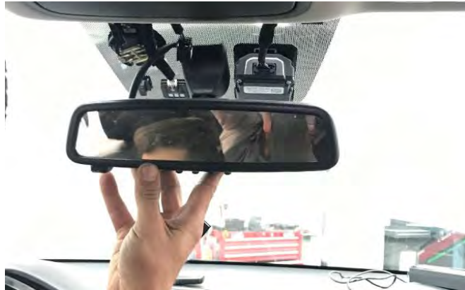
Fig. 4.9. Taxímetro de espejo
