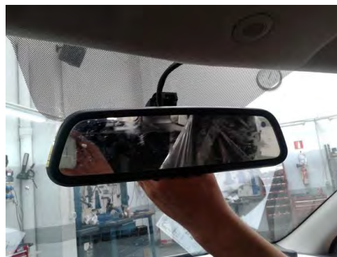
Fig. 6.2. Vistas de la disposici6n del taxímetro de espejo.
