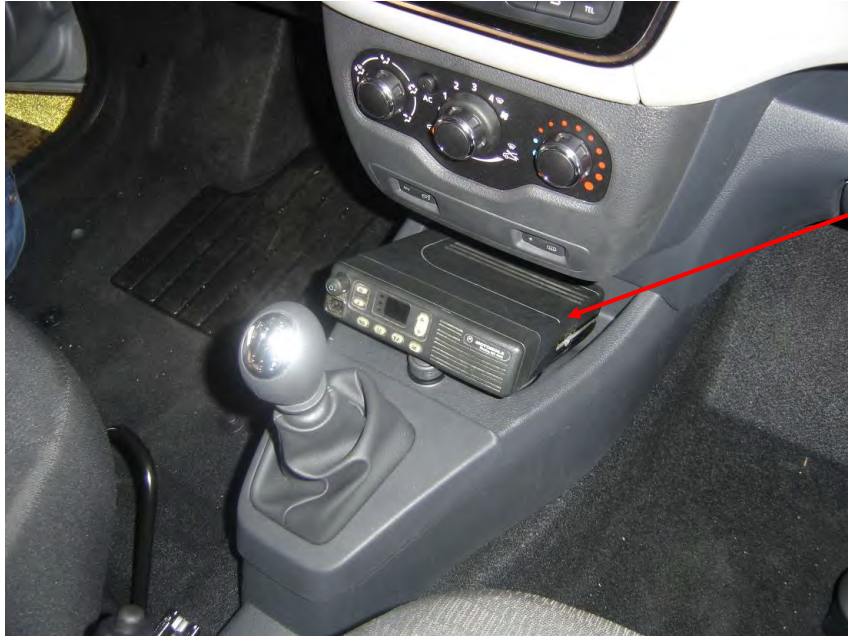
Fig. 9.4. Vista del posible emplazamiento de la emisora de radio.
