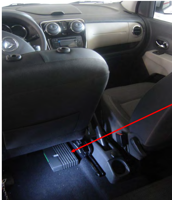
Fig. 9.1. Vista del emplazamiento del módulo de emergencias.
