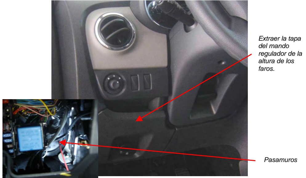
Fig. 1.3. Vista de la ubicación del pasamuros. Acceso de la instalación al habitáculo.
