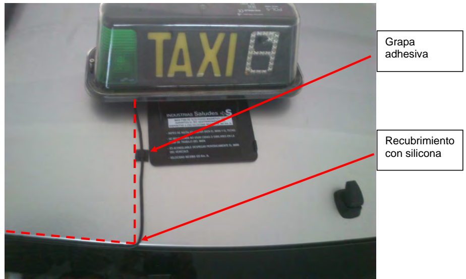
Fig. 8.3. Vista módulo fijado mediante placa imantada
