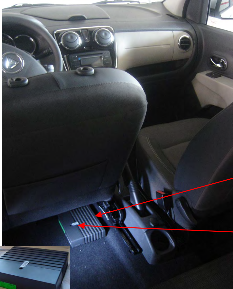
Fig. 3.5. Vistas de la caja adaptadora de señal con módulo de emergencias integrado.
