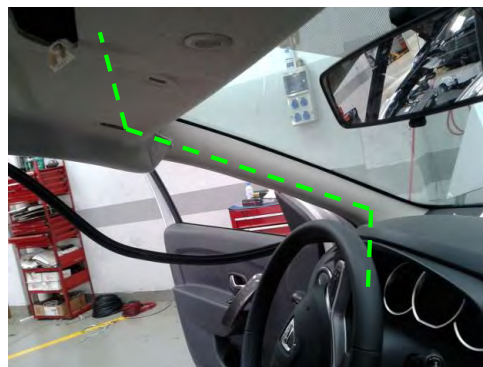
Fig. 8.8. Vista recorrido del cable del módulo
