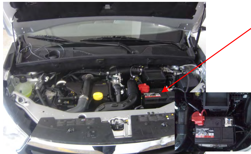
Fig. 1.2. Vista del alojamiento motor. Ubicación de la batería.
