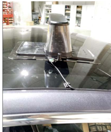
Vista de cable fijado con grapas adhesivas, módulo desplazado
