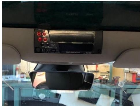
Fig. 8. Vista de un taxímetro de consola en la ubicación prevista en el techo.
