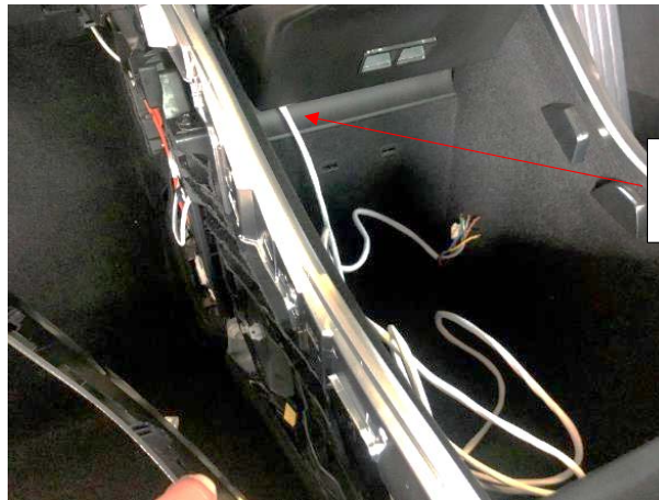
Salida del cable a guantera por la parte inferior de la tapa
