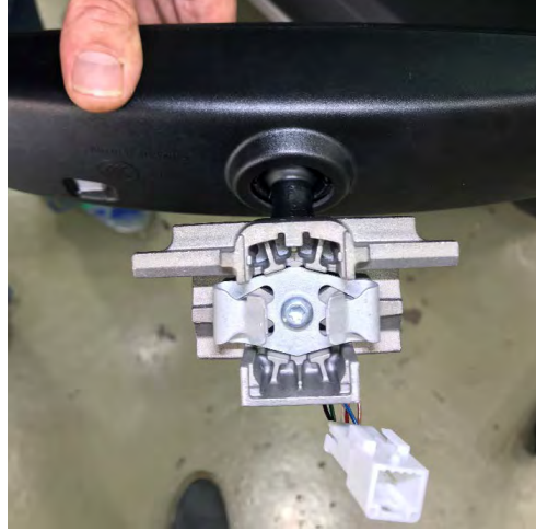
Fig. 4.7. Detalle de la sujeción del espejo retrovisor original a su soporte
