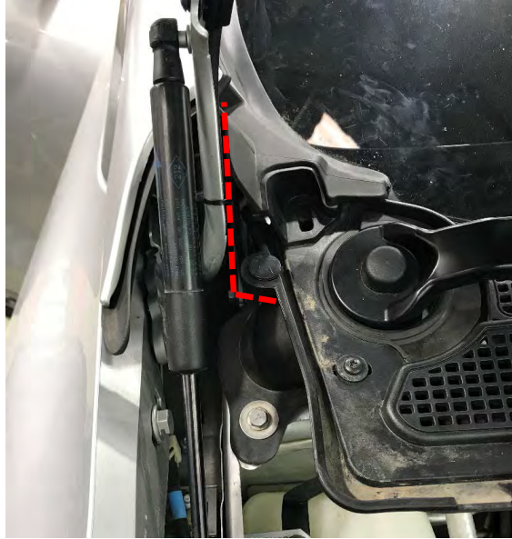
Fig. 6.7. Recorrido del cable del módulo
