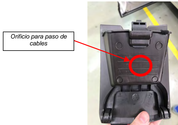
Fig 3.2. Zona de paso de cables en la guantera.
