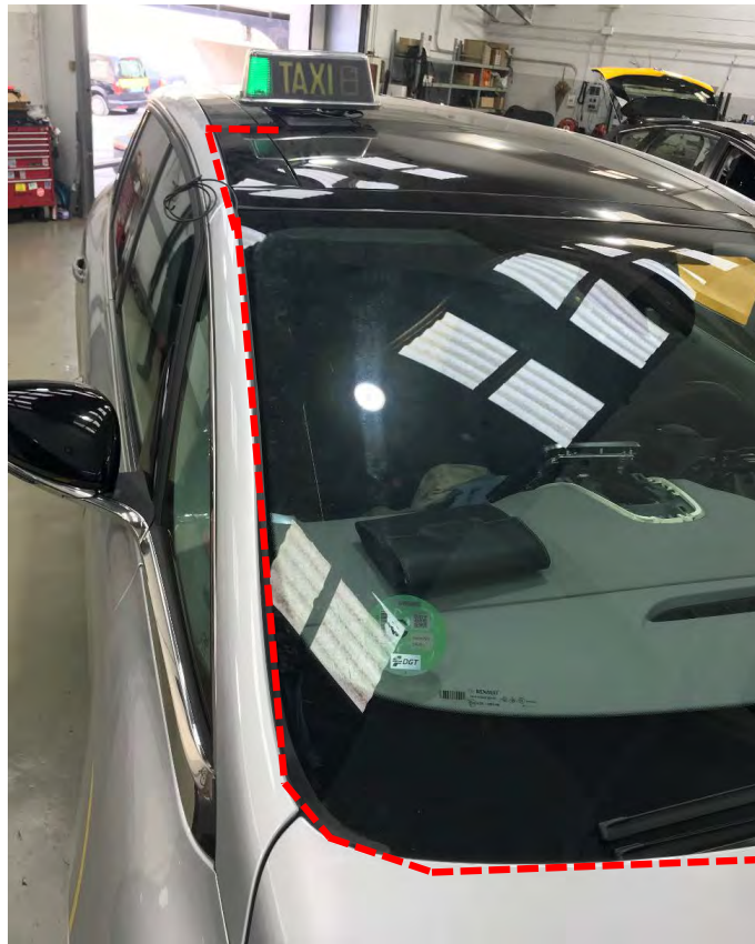
Fig. 6.6. Recorrido del cable del módulo
