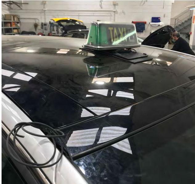
Fig. 6.1 Módulo luminoso sobre placa adherida al techo de cristal y soporte imantado
