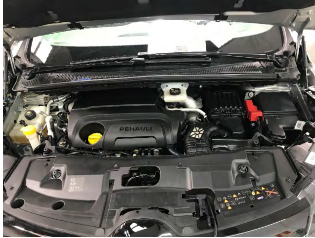
Fig 2.1. Vista del compartimento motor y posición de la batería
