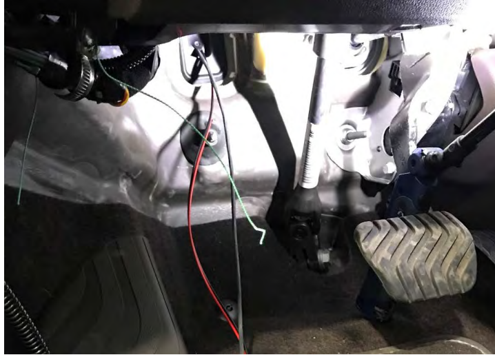
Fig 2.4. Imagen de pasamuros con el paso de cables de alimentación provenientes de las conexiones del compartimento motor
