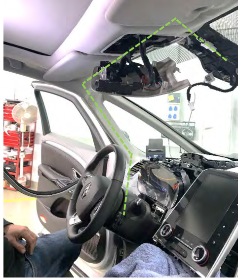
Fig. 4.4. Recorrido de los cables hasta el retrovisor
