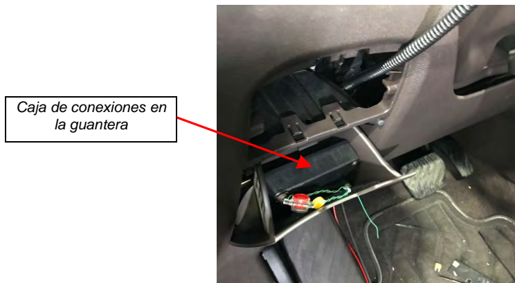
Fig 3.1. Ubicación de la caja de conexiones.
