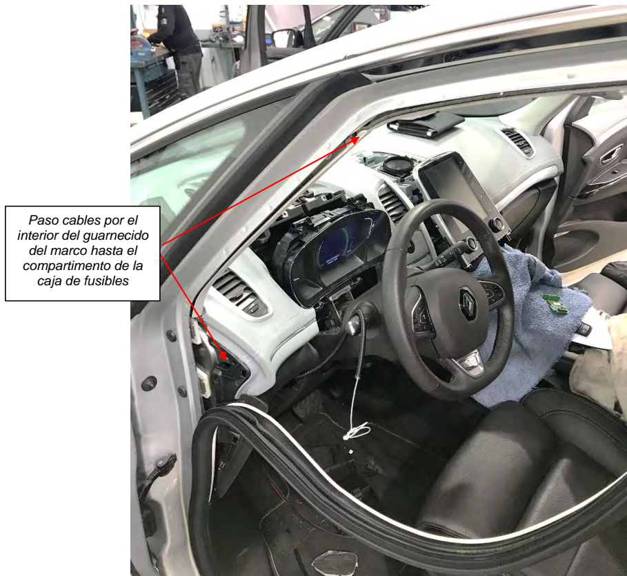
Fig. 4.3. Entrada y salida de cables a taxímetro
