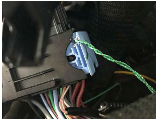
Fig. 3.4. Paso de alambre corrugado por el cierre del conector R107.
