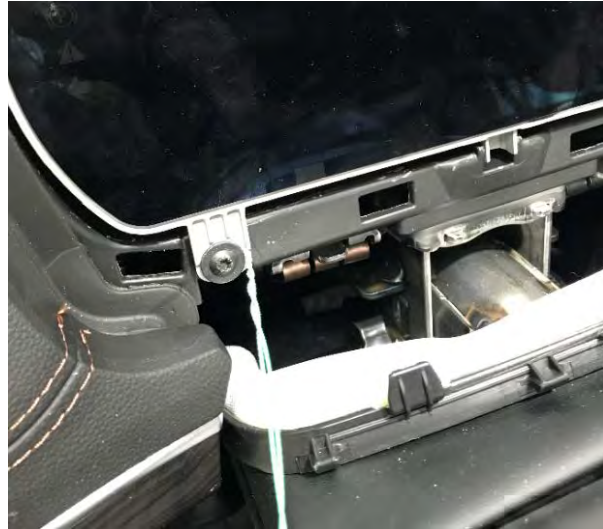
Fig. 2.2.5. Vista de la sujeción del alambre al soporte del cuadro
