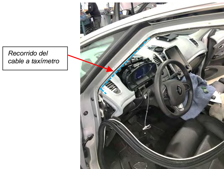
Fig. 5.2. Recorrido del cable de la impresora al taxímetro.
