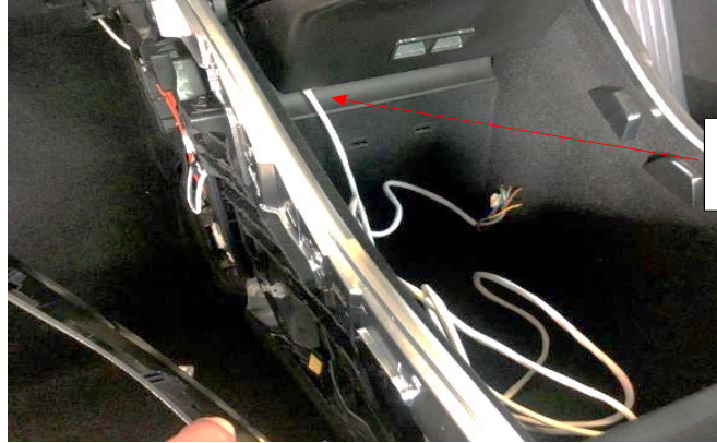
Salida del cable a guanterera por la parte inferior de la tapa
