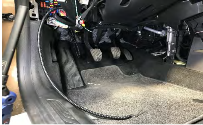
Fig. 3.1. Vista de la terminación de la manguera blindada puesta por el concesionario
