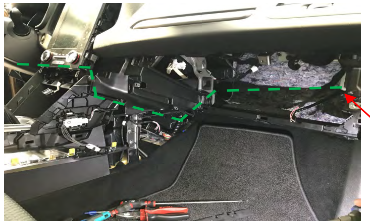
Fig. 2.4. Detalle paso cable de señal por detrás de la guantera y recorrido del cable por el interior del guamecido bajo el salpicadero
