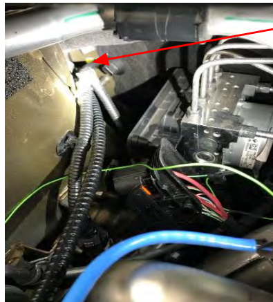
Fig. 2.2. Detalle pasamuros junto al módulo ABS/ESP, vista compartimento motor
