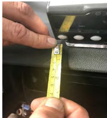
Fig. 5.2. Separación taxímetro a borde salpicadero.
