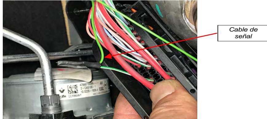
Fig. 2.1. Detalle conexión cable señal al cable del pin nº 3 del conector 1094
