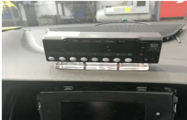
Fig. 5.1. Ubicación taxímetro consola sobre salpicadero.
