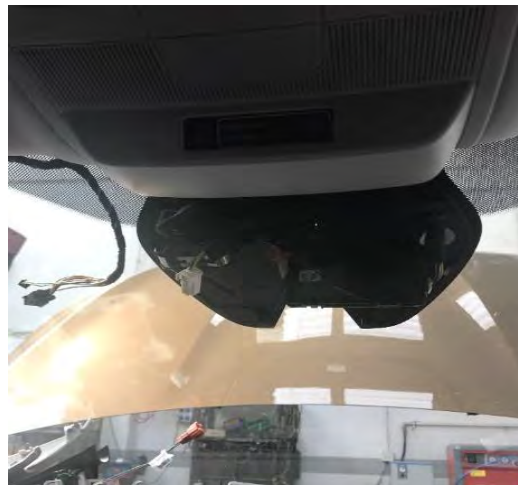
Fig. 5.4. Soporte para el taxímetro de espejo.
