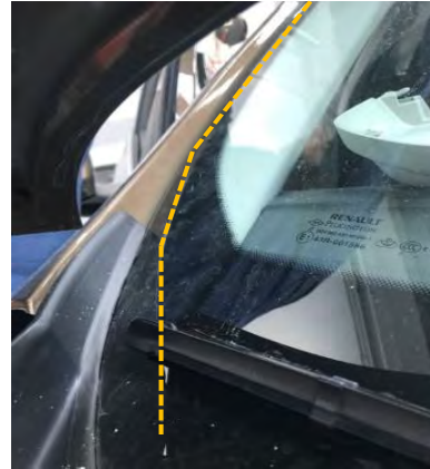
Fig. 6.5 y 6.6. Vistas del paso de cable del módulo al compartimento motor
